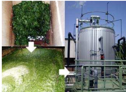
[그림 2-3-1] 일본 Tokyo Gas의 해조류를 원료로 한 메탄가스 생성공정.
