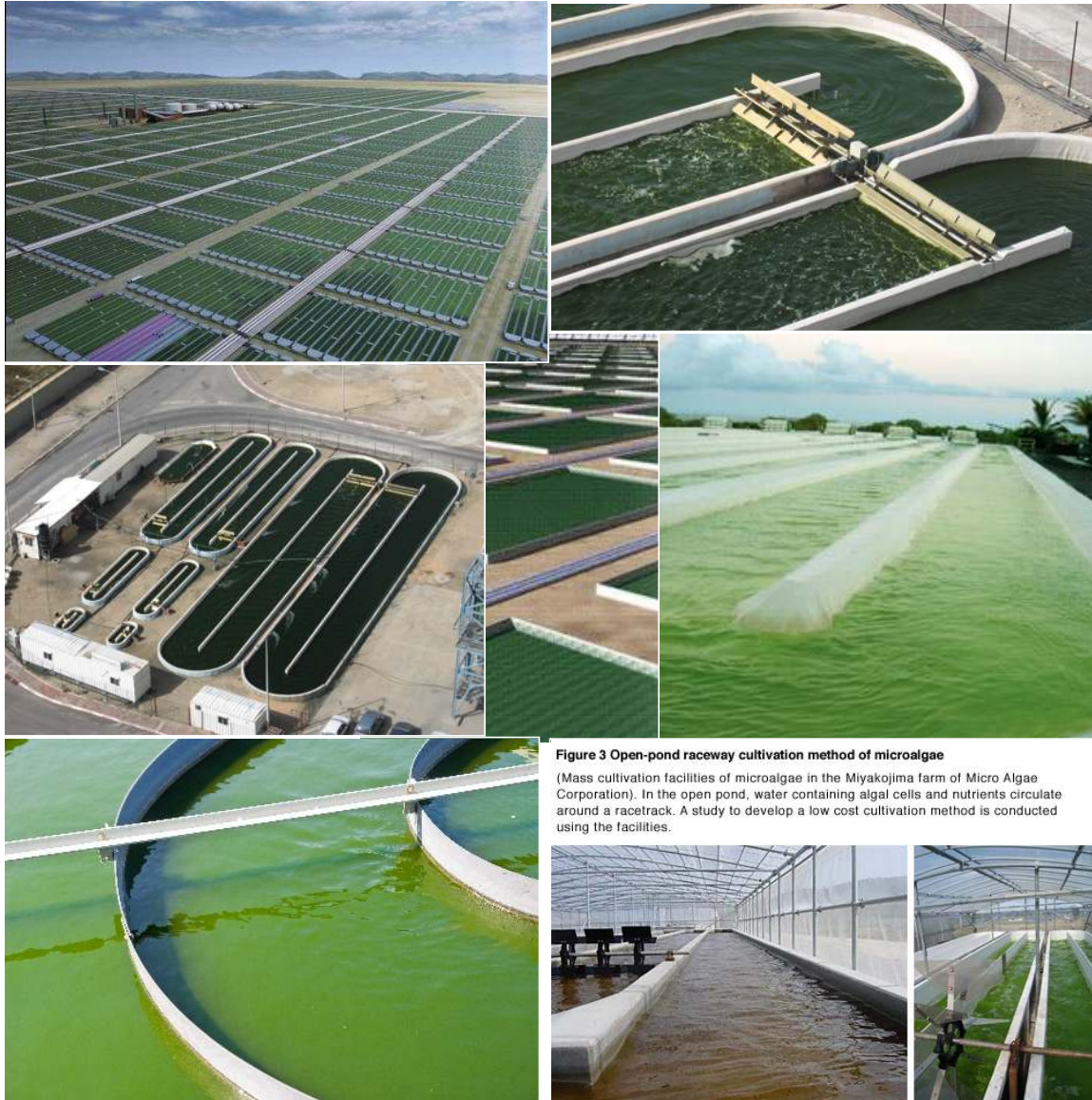
그림 2-2. 개방형 배양시설 open pond의 모습들. Raceway형이 대부분임.
