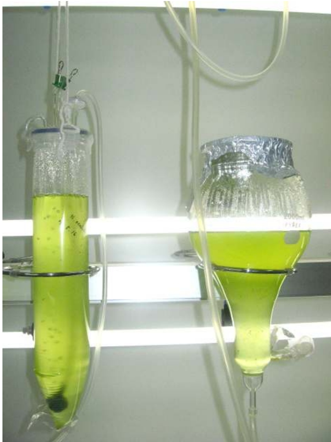
그림 3-25 : 뚜껑이 있는PE-vinyl bag (좌) 및 glass reactor(우)의 광배양 모습
