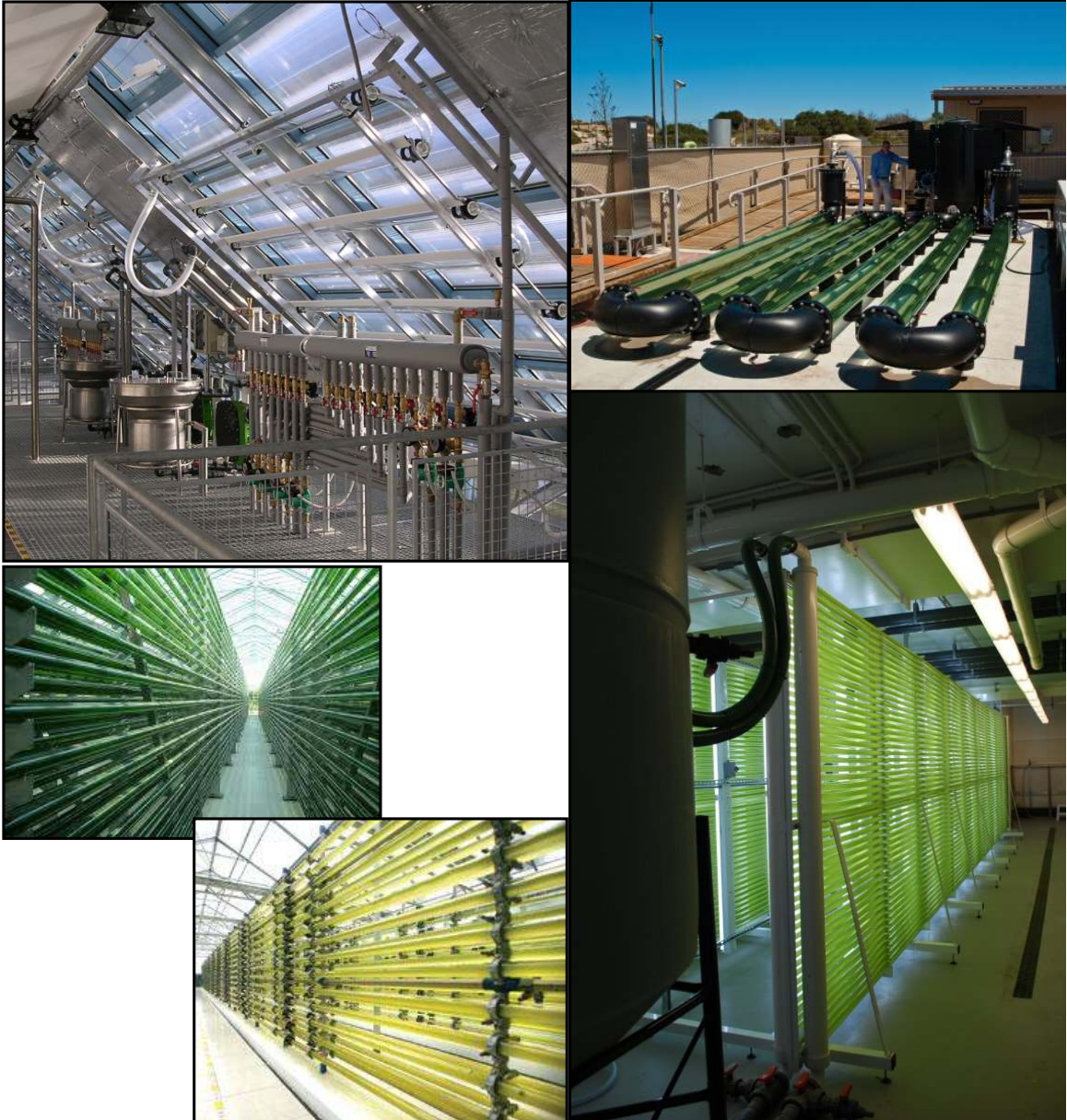
그림 2-3. 옥외 및 옥내에 설치된 tubular type의 PBR.
