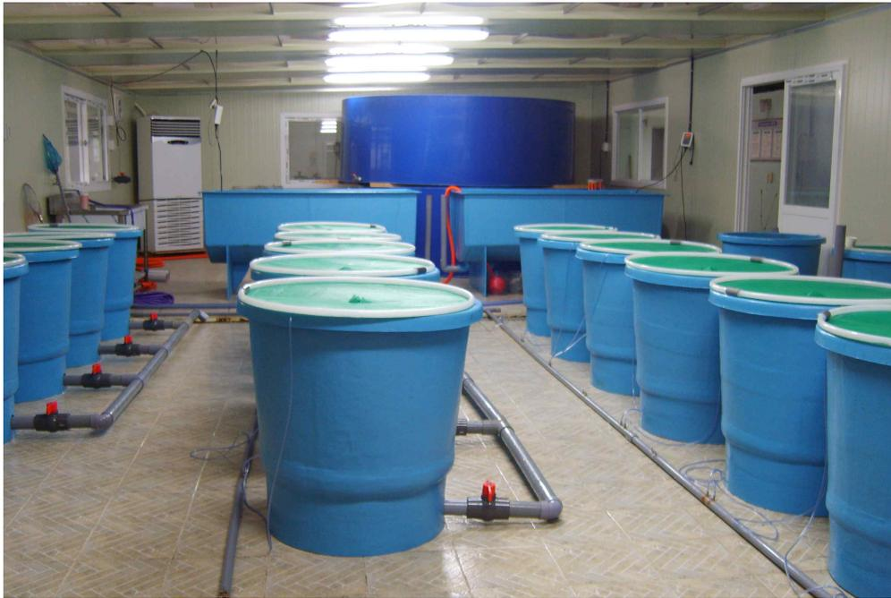
그림 1. 새우에 대한 사료첨가제의 기호성 실험을 수행하는데 사용된 사육장치와 사육수조
