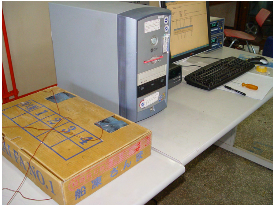
그림 22 열전대에 의한 해동 온도 측정 시스템
