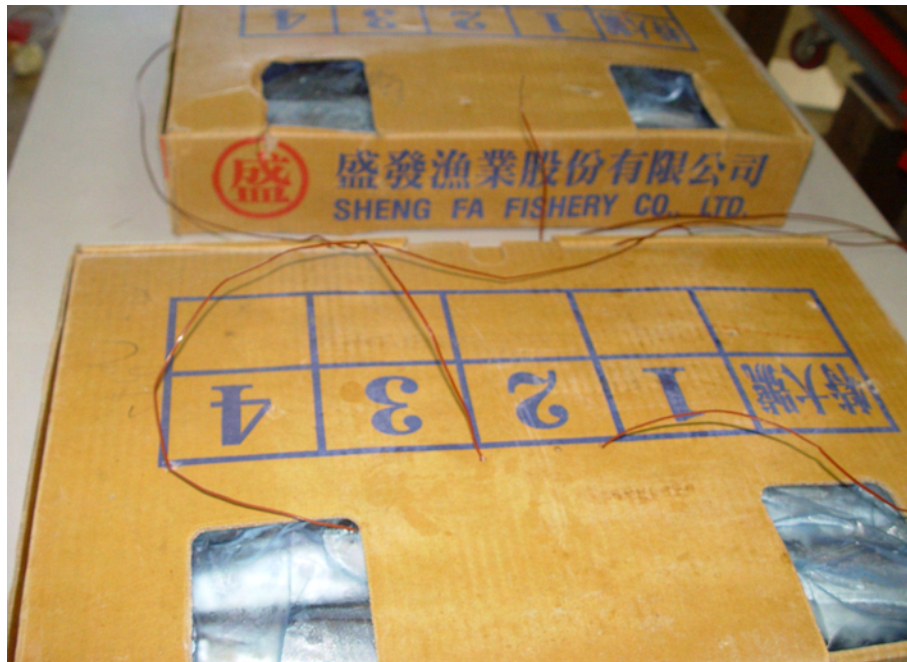
그림 21 콩치시료의 열전대 장착
