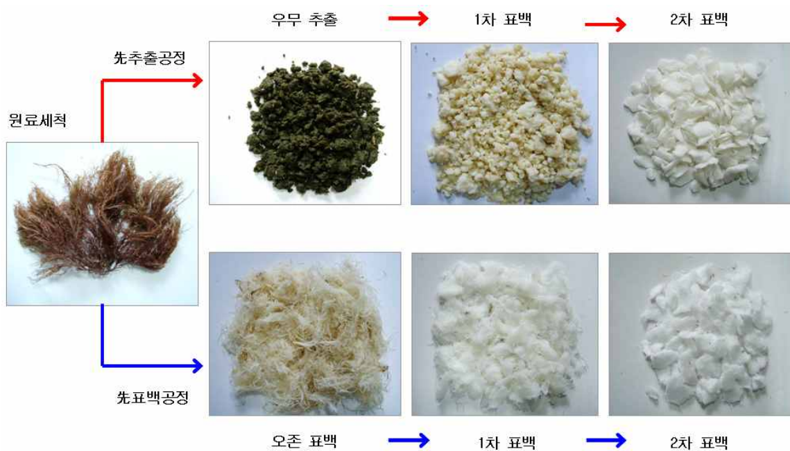
<그림 1> 홍조류 펄프 제조 공정
