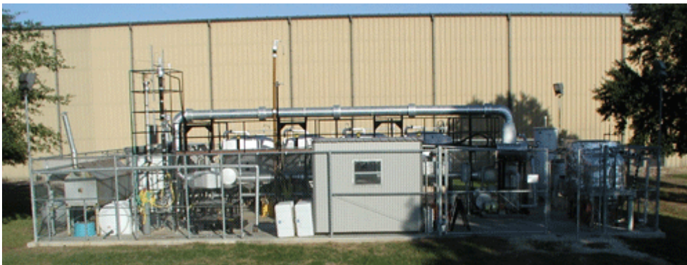
[그림 2-3-3] MixAlco 공정의 Pilot Plant (처리용량 100 Kg/일) (현재 이 그림보다 50배 용량인 5톤/일 규모의 실증시험 plant가 시험가동 중임)
