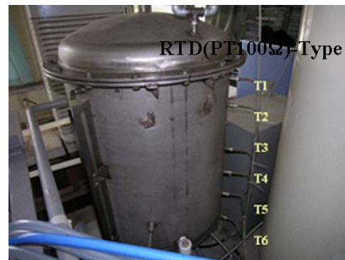
그림 48. Thermocouple positions in the vacuum tank.
