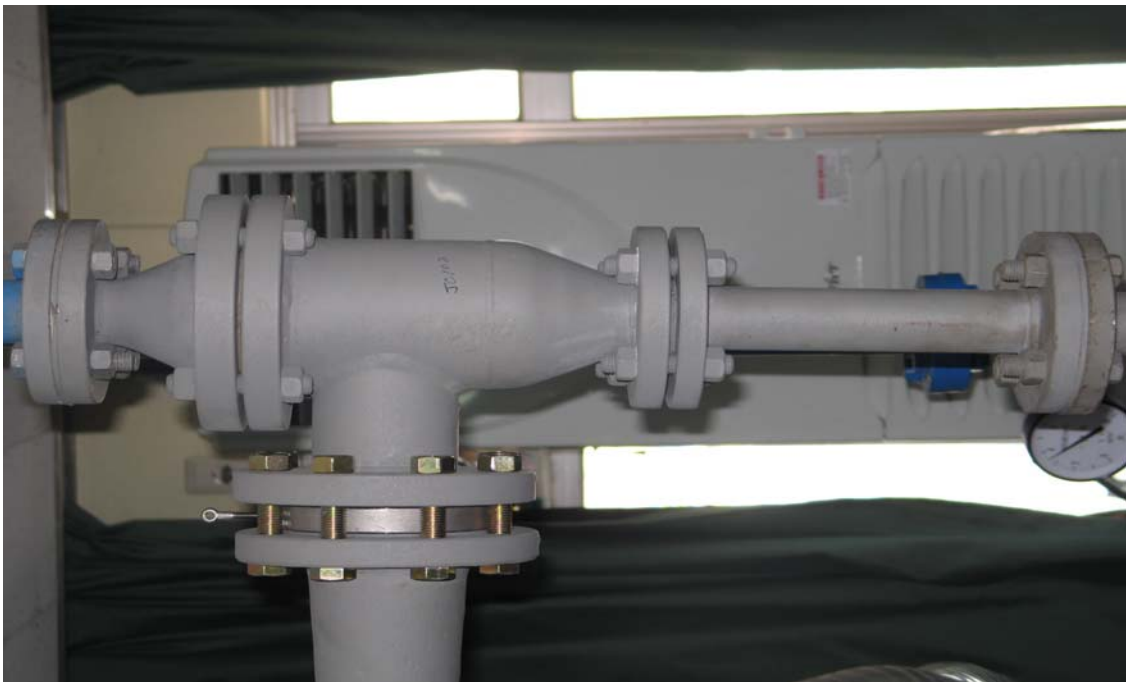
그림 9. 제트 콘덴서의 설계 도면과 사진.
