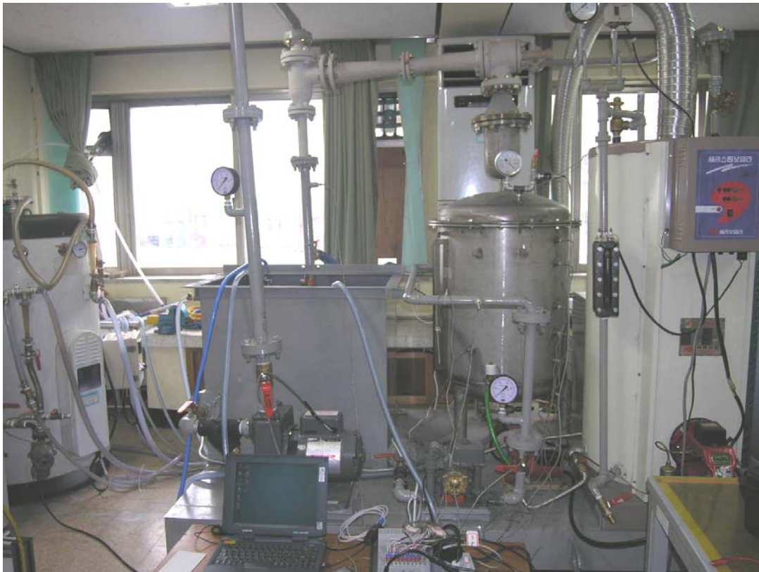
그림 30. 스팀 구동식 에젝터를 이용한 냉각 시스템의 개략도와 사진.
