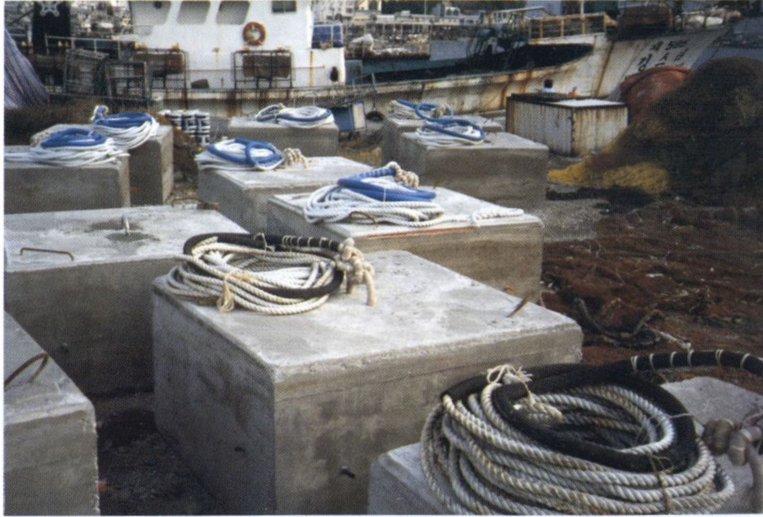
가리비 연승수하양식 시설 사각 콘크리트 앵카. Concrete block anchor for facilities of scallop culture.
