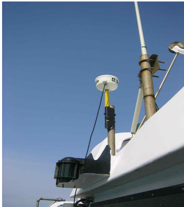
그림 2-1-4. Trimble DGPS 안테나.
