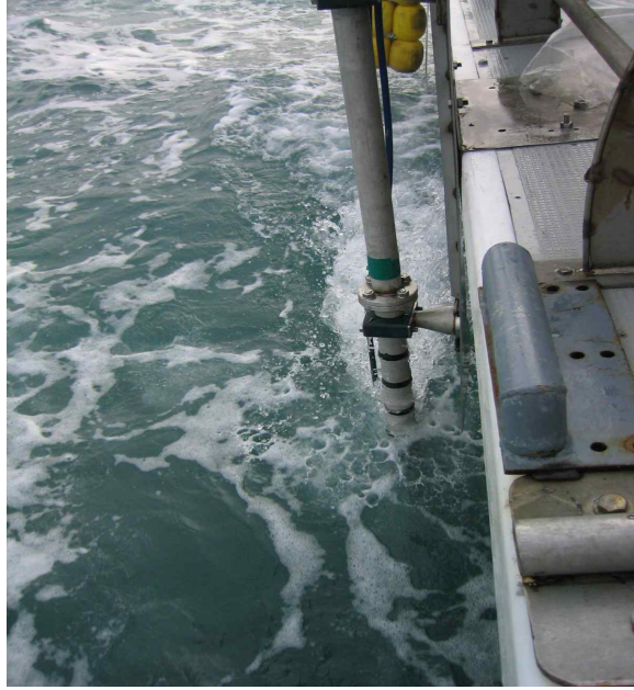
그림 2-1-9. 다중빔 음향트랜스듀서를 배 옆에 부착하여 예인하는 모습.
