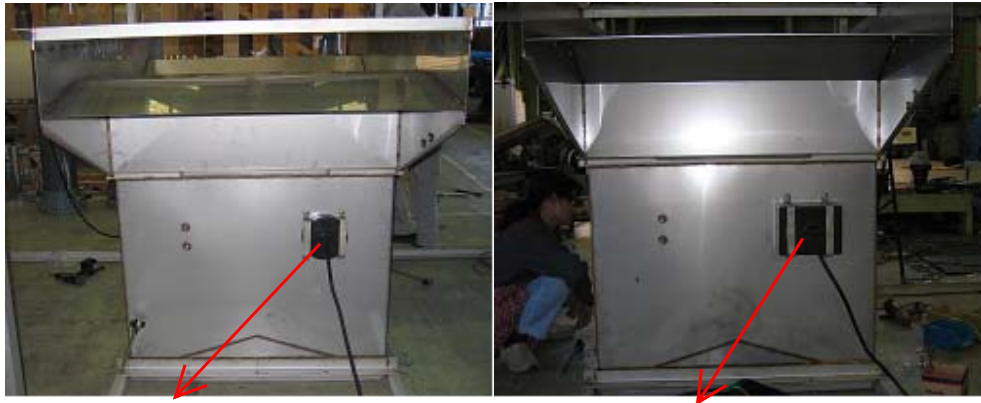
그림 128. 수류발생부에 부착된 초음파 발생장치. (좌)원형초음파발생장치, (우)사각형 초음파 발생장치
