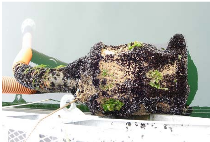
그림 268. 취수구의 스트레이너에 부착된 부착생물
