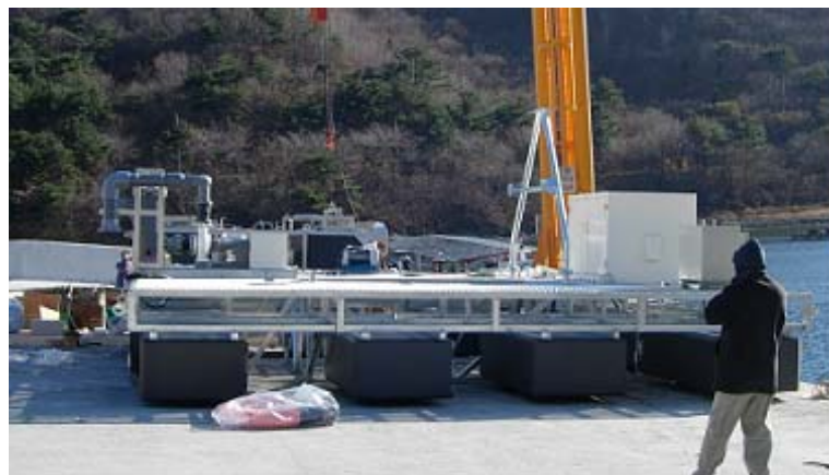
그림 243. 조립 체결된 플로트에 각 장비들 부착
