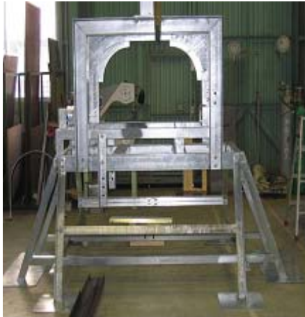
그림 203. 수류발생장치 MJS-150과 거치대의 제작 모습
