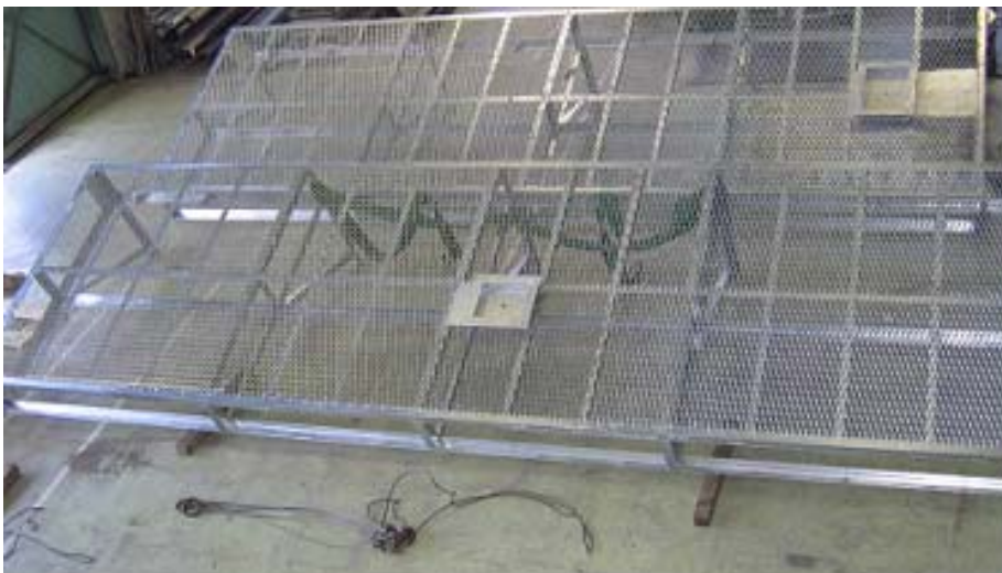
그림 230. 아연을 도금한 플로트의 모습
