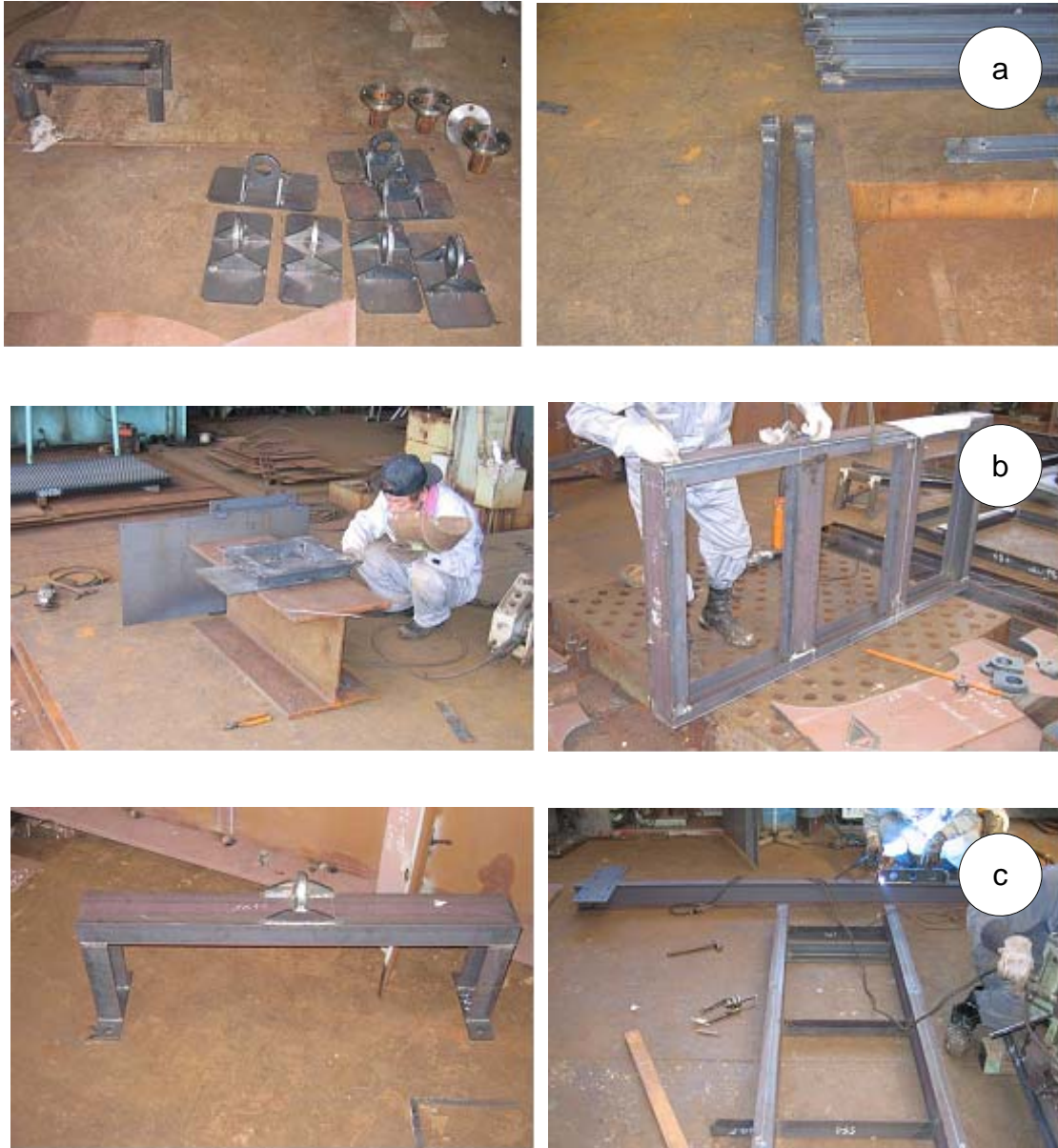
그림 225. 플로트 구조물들의 각 부위별 소품 제작. (a) 플로트 연결 고리 부품 및 앵글 부품, (b) 플로트 앵글 판넬 부품, (c) 플로트 각 연결 앵글 부품
