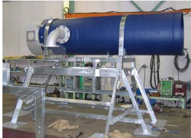
그림 203. 수류발생장치 MJS-150과 거치대의 제작 모습
