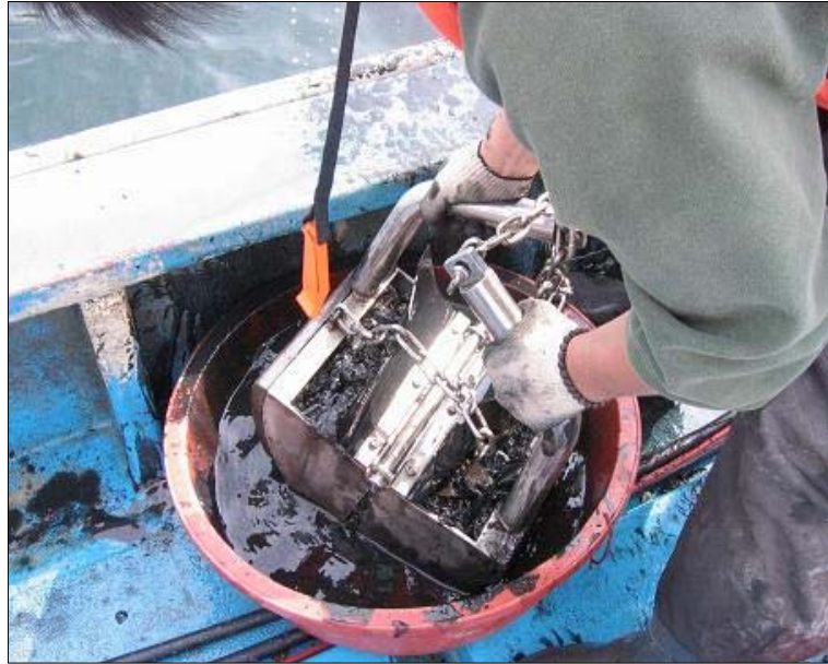
그림 43. 변형된 채니기(van Veen grab)를 이용한 대형저서동물 채집.
