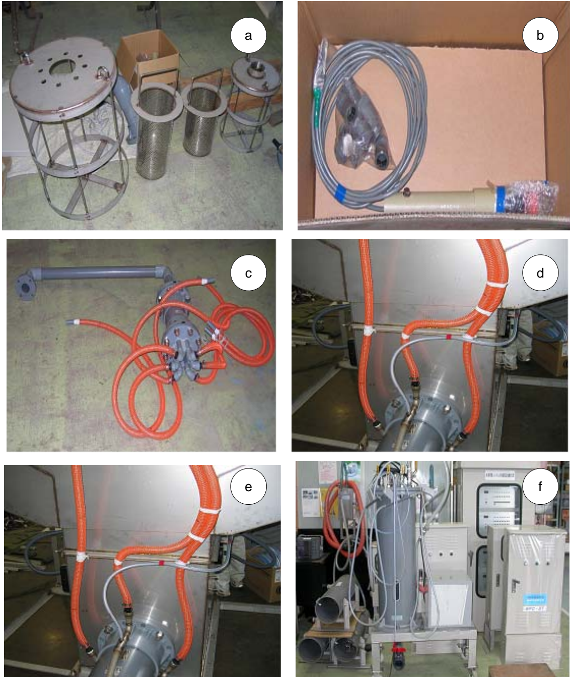
그림 136. 소형실험장치에 부착되는 각종 부속품. (a)스트레이너 및 정류통 내부 필터, (b)경광등, (c)오존 공급 밸브 및 호스, (d)오존 공급 밸브 및 파이프, (e)노즐에 연결된 오존공급밸브, (f)정류통 및 기타 부속품.
