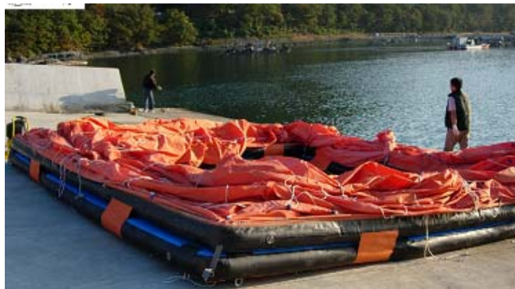
그림 109. 공기구조물 메소코즘에 차단 방지막 부착
