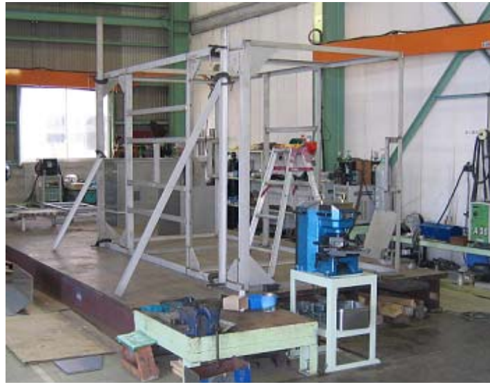
그림 133. 제작중의 소형 실험장치의 프레임
