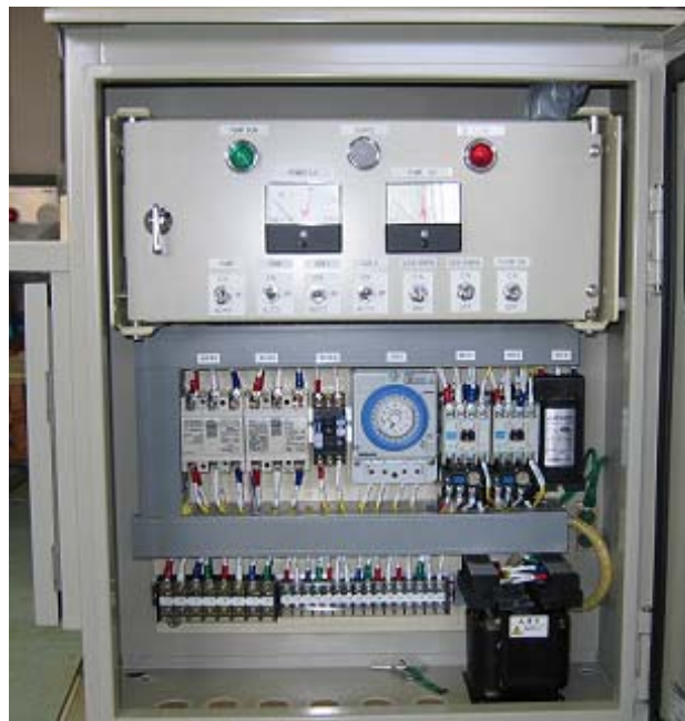
그림 135. 소형실험장치의 운전 제어박스의 내 외부 모습.
