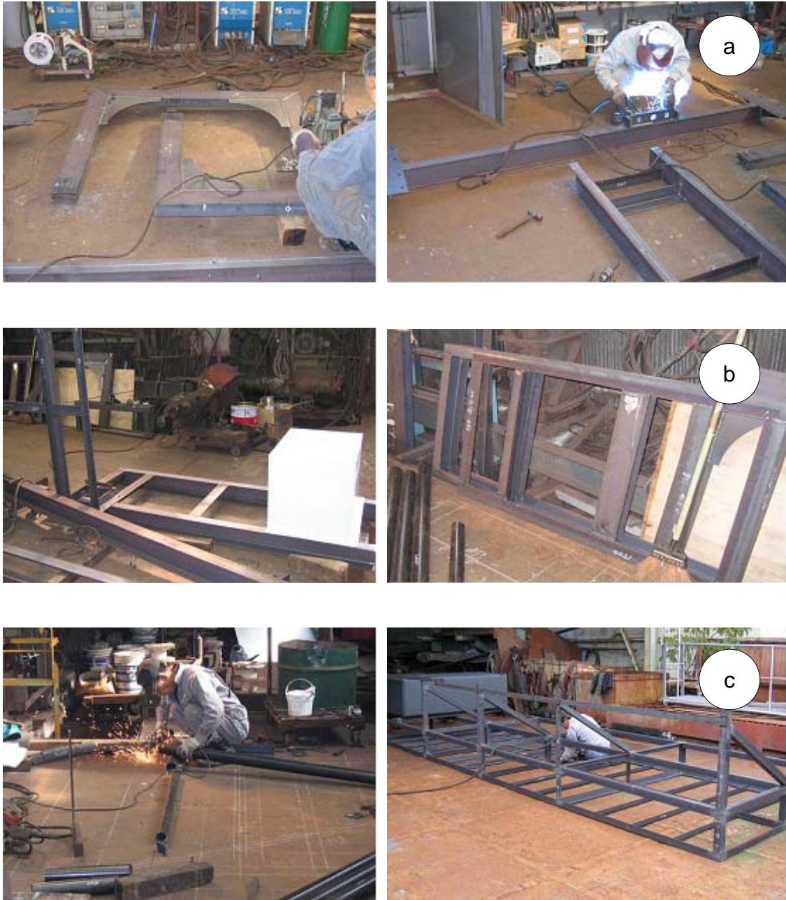
그림 226. 파트별 구조물 제작과 재결합 제작. (a) 파트별 구조물 제작, (b) 파트별 구조물 제작, (c) 용접과 파트별 구조물 결합제작
