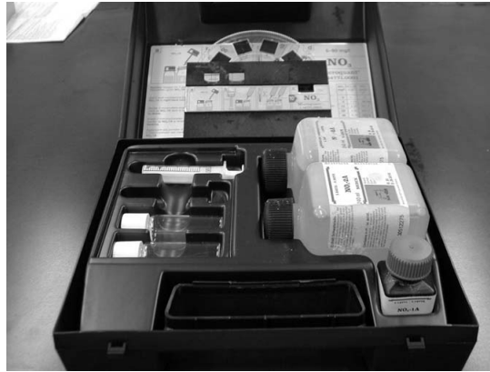
그림 4-7. 수질 간이측정키트. 암모니아, 아질산염, 알칼리도, pH 등을 현장에서 측정 가능하다.
