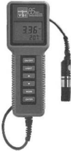
그림 4-6. DO 메터. 용존 산소, 수온, 염분의 동시 측정이 가능하다.
