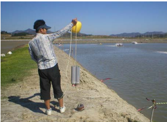
그림 3. 침전물 채취기 및 채취된 침전물 그림 4. 바닥개선제 실내실험 장치
