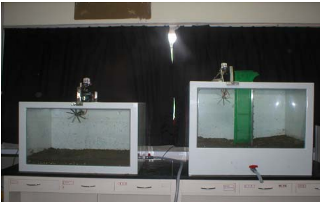
그림 5. 실내 새우 양식장 실험 반응조, 왼쪽은 기존의 새우양식장 모형이고, 오른쪽은 구조 개선된 새우 양식장
