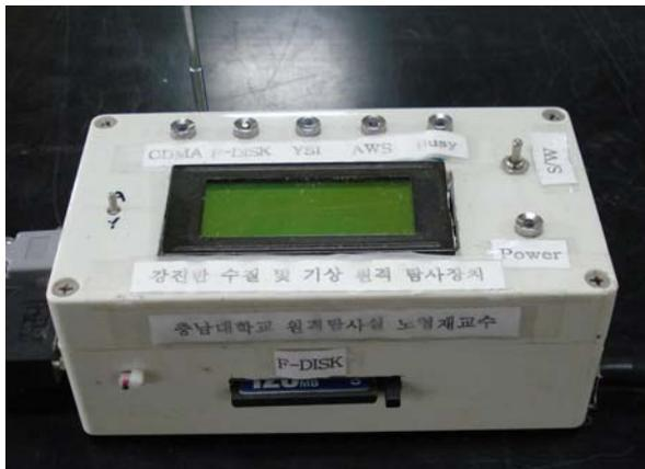
사진 3-2. CDMA 모듈을 이용한 data logger
