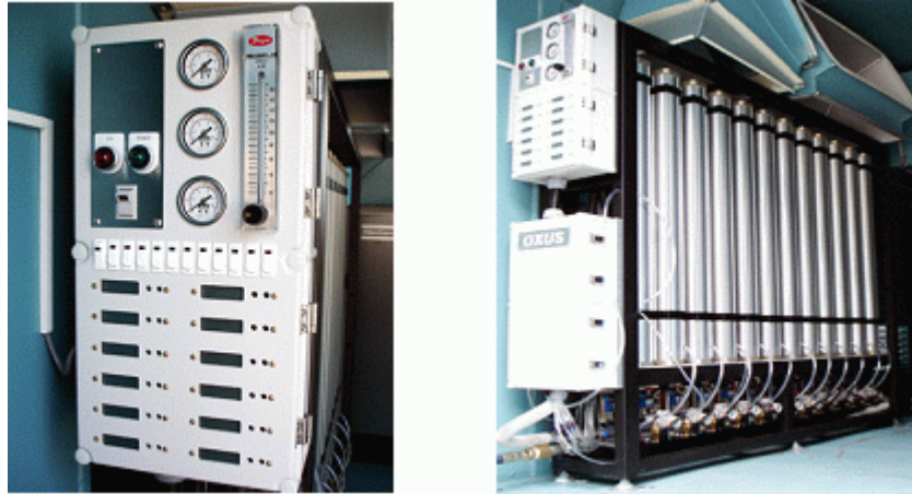
[그림 3-32] 시작품 조작부 및 산소발생 랙프레임
