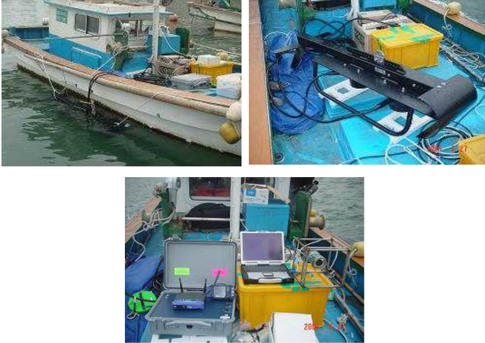
그림 3-3-5. 음향 자원조사를 위한 예인체 설치, 음향 센서 및 저장 시스템.
