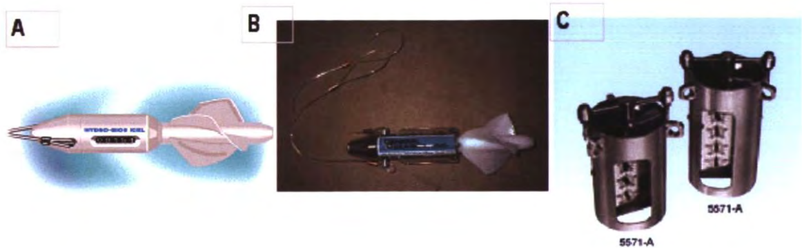
[그림. I-29] 대표적인 플랑크톤 네트용 유량계. A; Hydrobios사, B; GO사, C; Rigosha사
