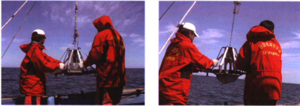
[그림. I-36] Smith-McIntyre grab. 왼쪽: 채니하기 위해 내리려고 하는 상태. bucket의 입구가 열려 있다. 오른쪽: 채니하고 올라 온 상태. bucket의 입구가 닫혀 있다.
