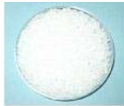
토코페롤 옥테이트 (Tocopherol octate) 함유 Master batch와 LLDPE (Linear Low Density Polyethylene) 혼합물
