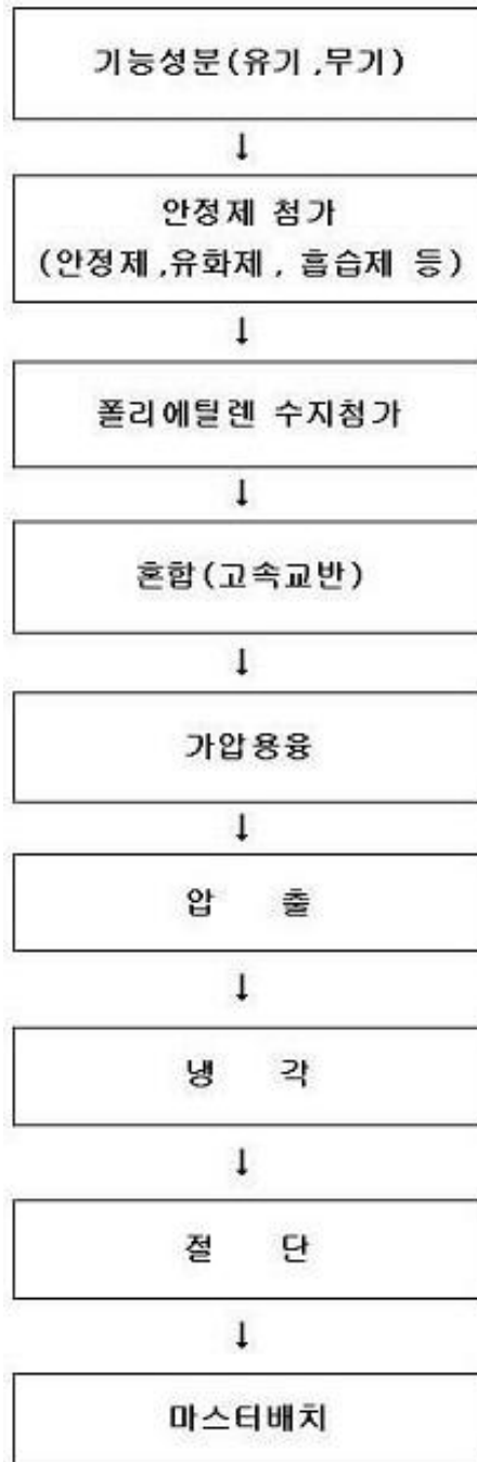
그림 133. 기능성 PE 필름 가공용 master batch 가공 공정도
