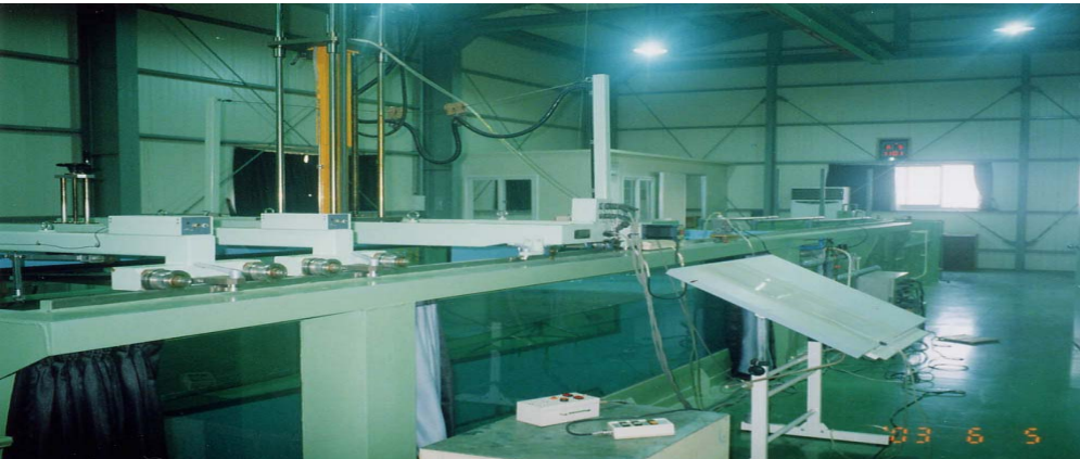
<그림 5-55> 회류수조 관측부 유속계측시험 모습
