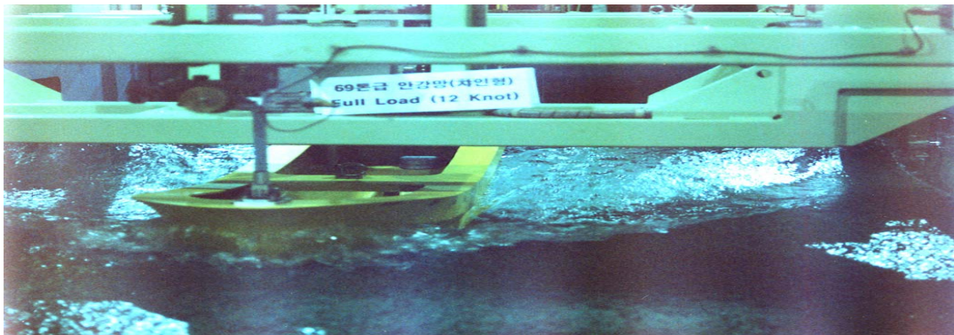
<그림 5-59> 69톤급 근해안강망어선 설계1선(차인선형)의 선수부 파형모습 (만재, 12 노트)
