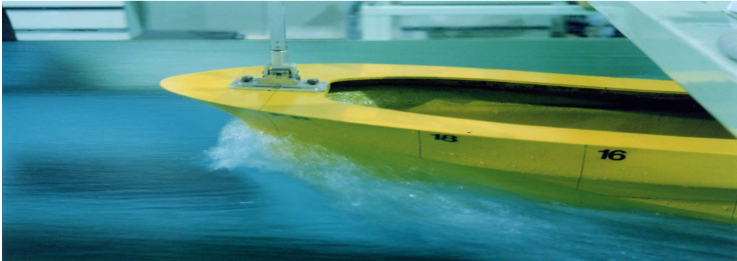
<그림 5-57> 69톤급 근해안강망어선의 설계1선(차인선형) 선수측면 파형관측
