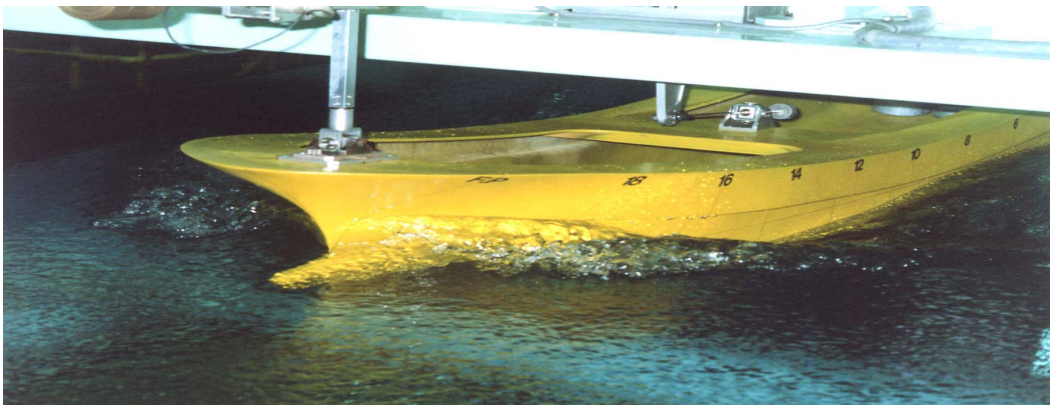
<그림 5-58> 69톤급 근해안강망어선의 설계2선(곡선형) 선수측면 파형관측
