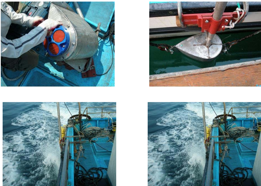
그림 1-1-4. 탈·부착식 ADCP 유속계 현장관측 사진.
