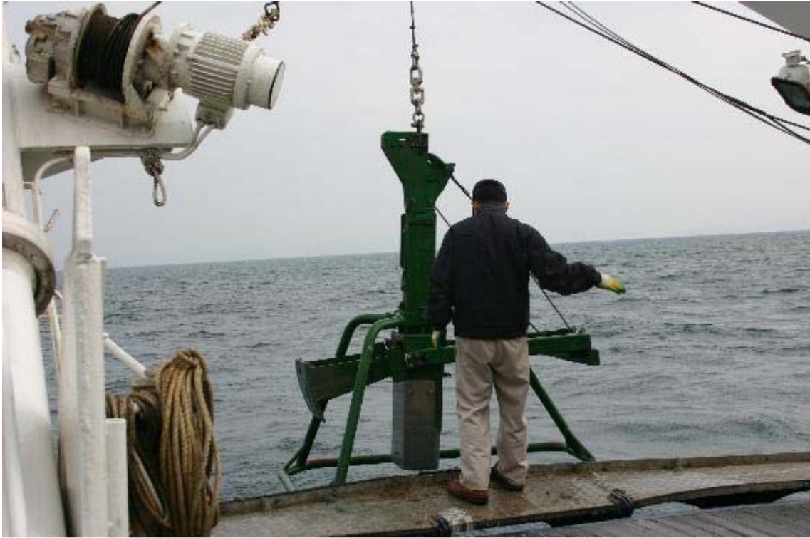
그림 2-1-2. 퇴적물 시료채취에 이용된 박스 코어와 시료채취 장면.
