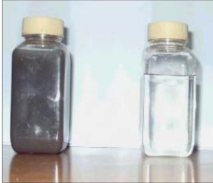
사진 15. Filter Press에 의한 배출수(실험 전, 후)
