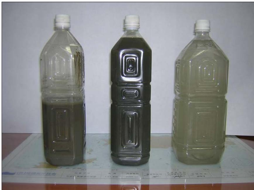
사진 14. 원심분리기를 이용한 배출수 상태
