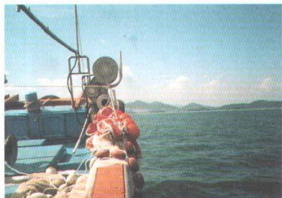
<그림 66> 실험 선박에 설치된 선수 양망기(좌: 양망기를 선내로 돌려놓은 상태, 우: 양망기를 선외로 돌려놓은 상태).
