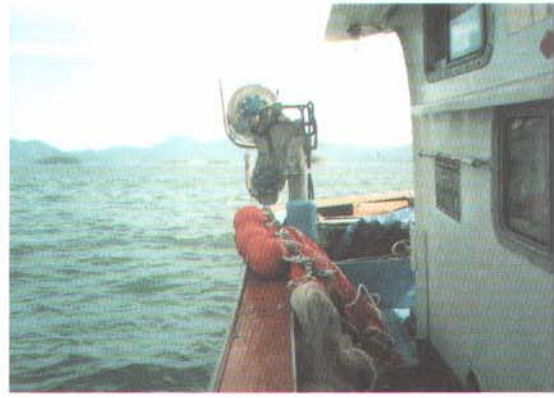
<그림 67> 실험 선박에 설치된 선미 양망기(좌: 양망기를 선내로 돌려놓은 상태, 우: 양망기를 선외로 돌려놓은 상태).
