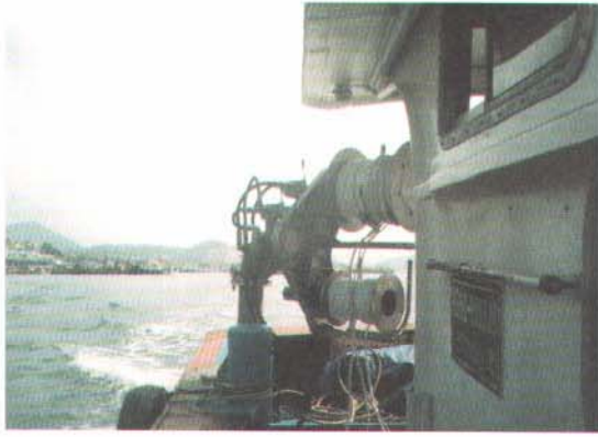
<그림 67> 실험 선박에 설치된 선미 양망기(좌: 양망기를 선내로 돌려놓은 상태, 우: 양망기를 선외로 돌려놓은 상태).
