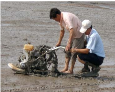
그림 29. 뺨에서 정지 재출발 시험
