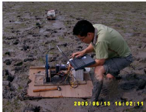
그림 18. 빨배의 저항 측정 시험
