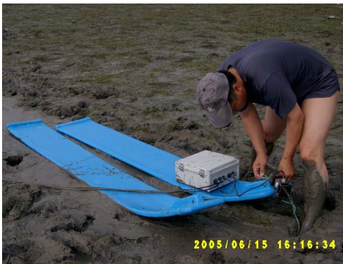
그림 17. 빨배의 저항 시험 준비
