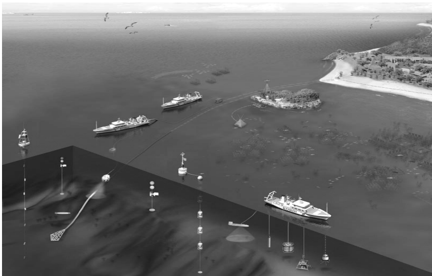
그림2-2 해양심층수 취수시설 설치 조감도
