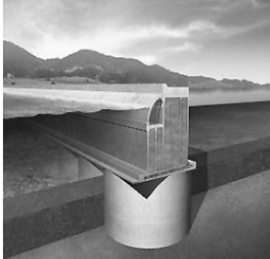
그림2-7 대수심 연약지반 방파제(Suction Pile 기초) 개념도
