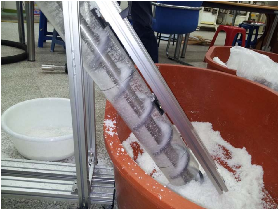
그림 28 스크류 호스 방식에 의한 천일염 자동 이송 모형 시험
