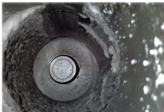
그림 24 사이클론 내부 표면에 빠르게 소금 점착되어 사이클론 구조적 형상 때문에 유지 보수 어려움
