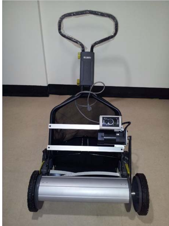
그림 42 롤러 스크류 부가장치 적용 수동식 버킷타입 채염장치 간이 모형
