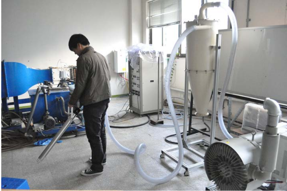
그림 25 링블로워 자동이송장치 2차 모형 제작
