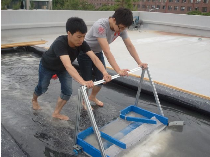
그림 40 버킷 타입 채염장치 설계를 위한 모형 시험
