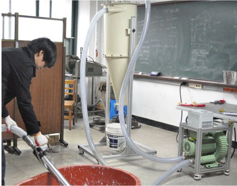
그림 18 링블로워를 적용한 흡입 분체이송 실험 모습
