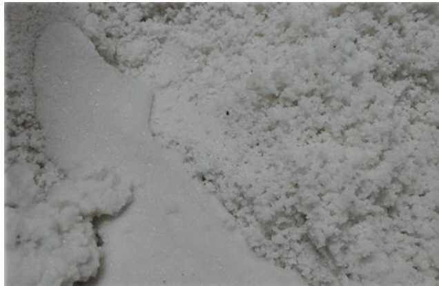
그림 23 이송 중 소금이 잘게 분쇄되며 겉보기 점도 (bulk viscosity) 급격히 증가되며 ,또한 이송 후 상품성이 떨어지는 손실을 가져옴
