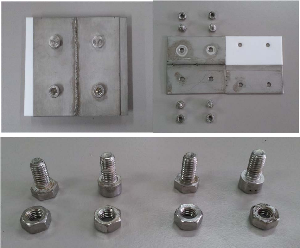
그림 45 시험온도 25\pm 1^{\circ}\text{C} 에서의 시편(좌상 : 결합체 / 우상 : 분해 / 하 : 볼트, 너트)
