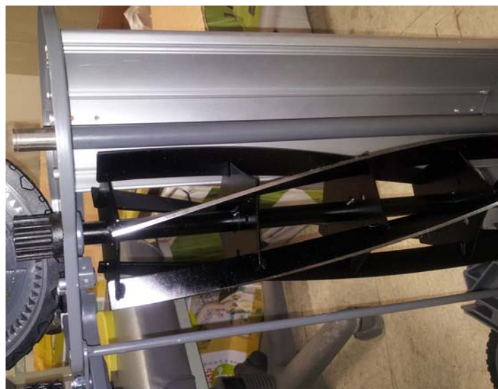
그림 41 버킷 앞쪽의 침전된 소금 이송을 위한 롤러 스크류 형태의 부가장치
