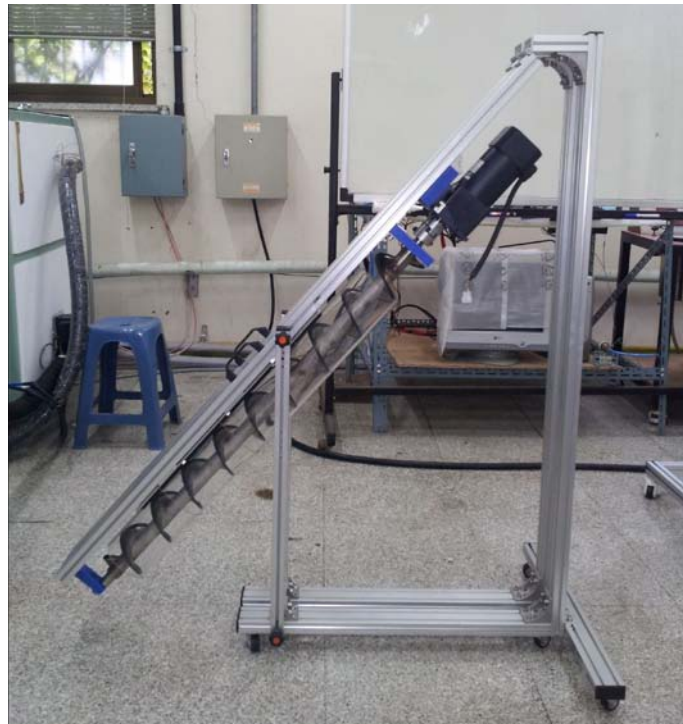
그림 26 스크류 호스 방식의 자동 이송 시스템 실험 모형
