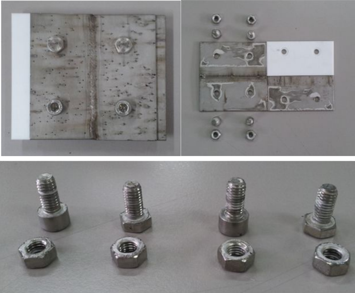
그림 46 시험온도 50\pm 1^{\circ}\text{C} 에서의 시편(좌상 : 결합체 / 우상 : 분해 / 하 : 볼트, 너트)
