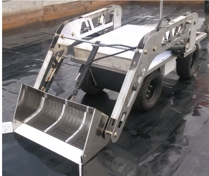
그림 65 자동 채염시스템 시제품 프레임부 및 버킷 구동부 제작 완성
