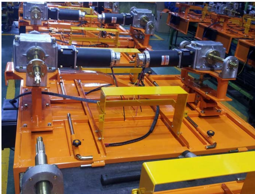
그림 61 자동 채염시스템 버켓부 구동 유압시스템 설치 제작
