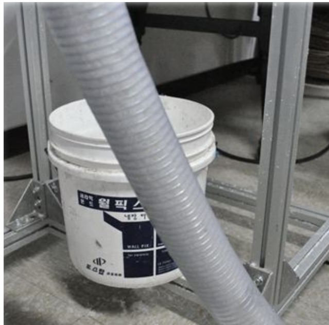
그림 21 수직관 부분에서의 천일염 침전에 따른 막힘 현상이 시작되는 모습
