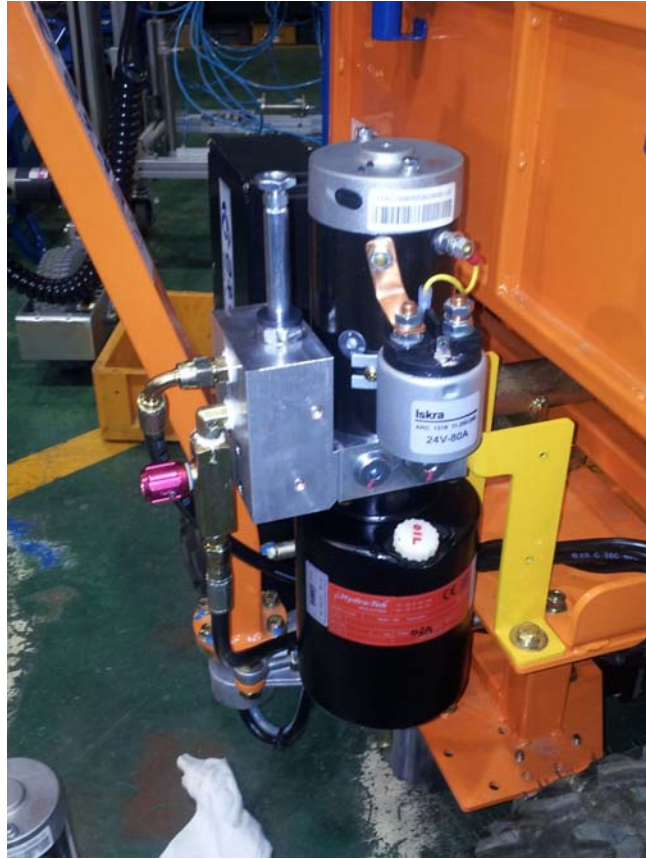
그림 62 자동 채염시스템 구동부 유압시스템 설치
