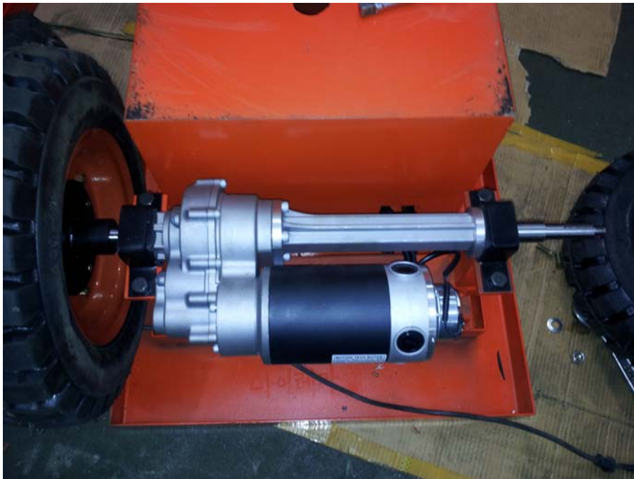
그림 64 자동 채염시스템 구동 동력부(모터, 차동장치)
