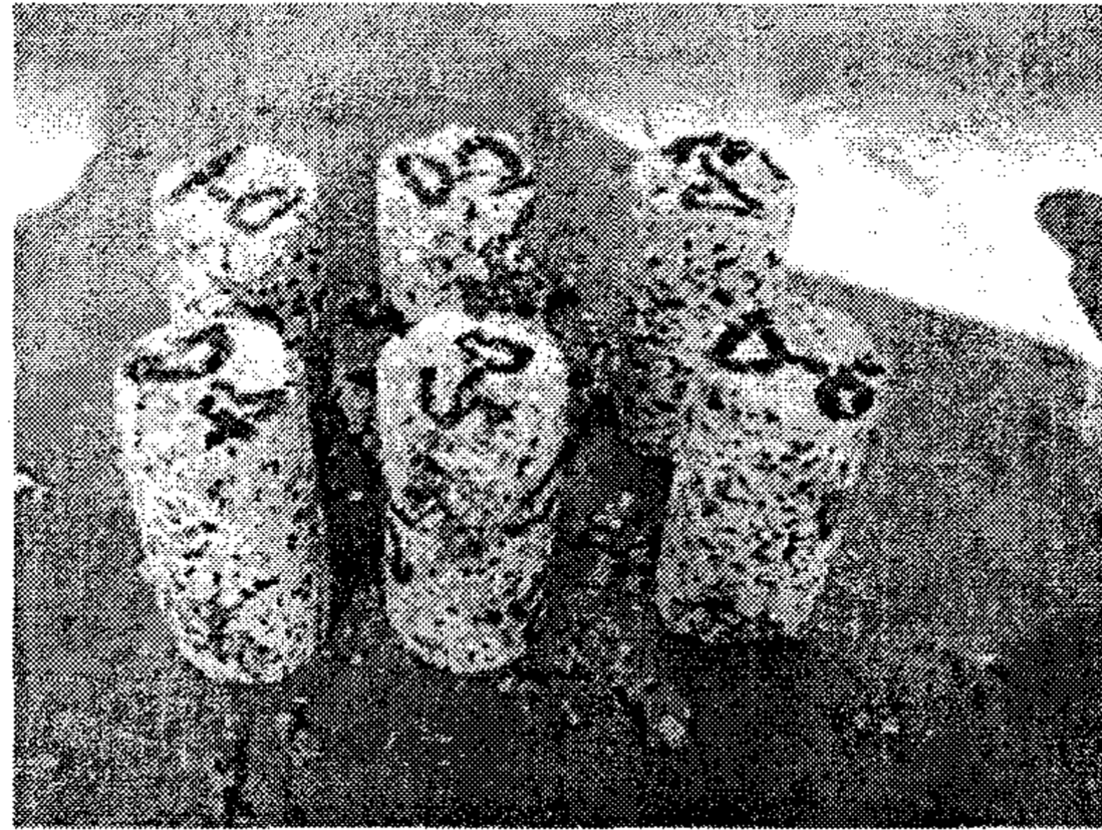
<그림 3-24> 압축강도 시험 후 D시험체 파괴양상
