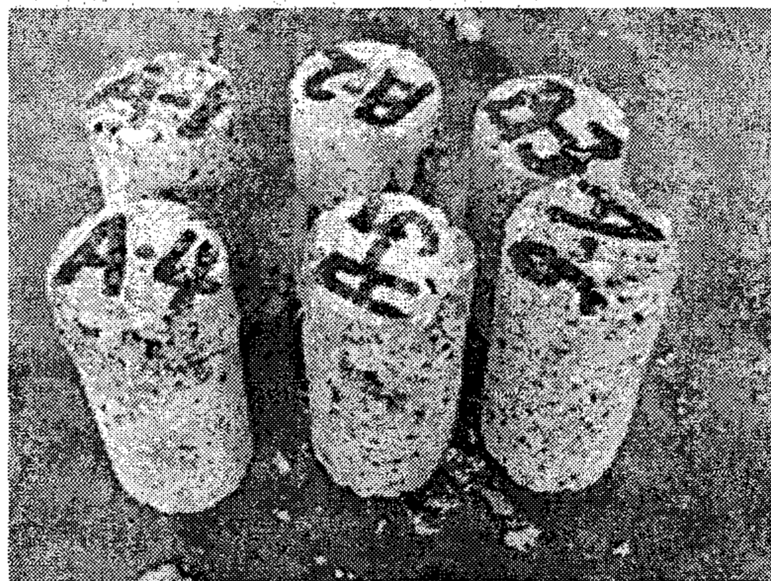
<그림 3-21> 압축강도 시험 후 A시험체 파괴양상
