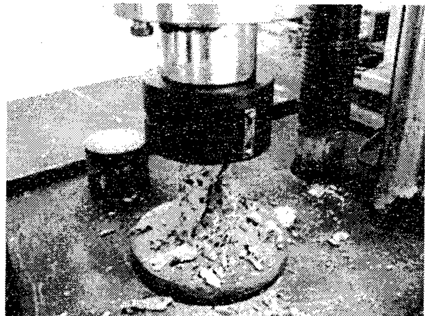
(d) 코어의 압축강도 시험 전경
