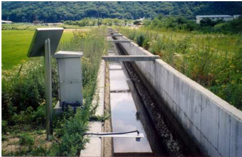
<그림 5-3> 관개량 계측 장치(이동용수간선)
