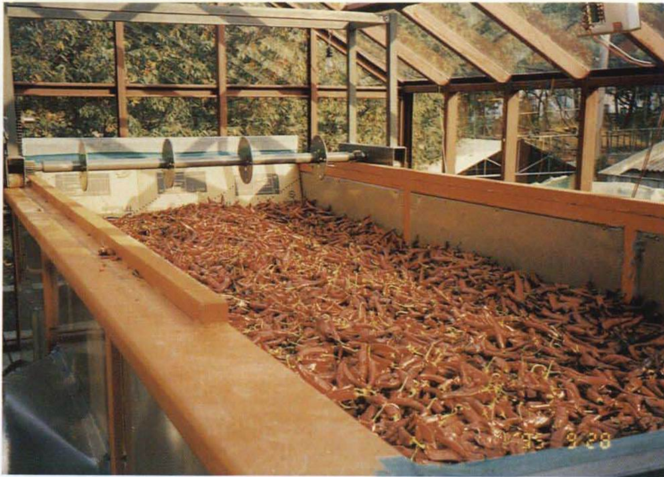
그림3-7 복합열 태양초 자동건조기의 건조조
