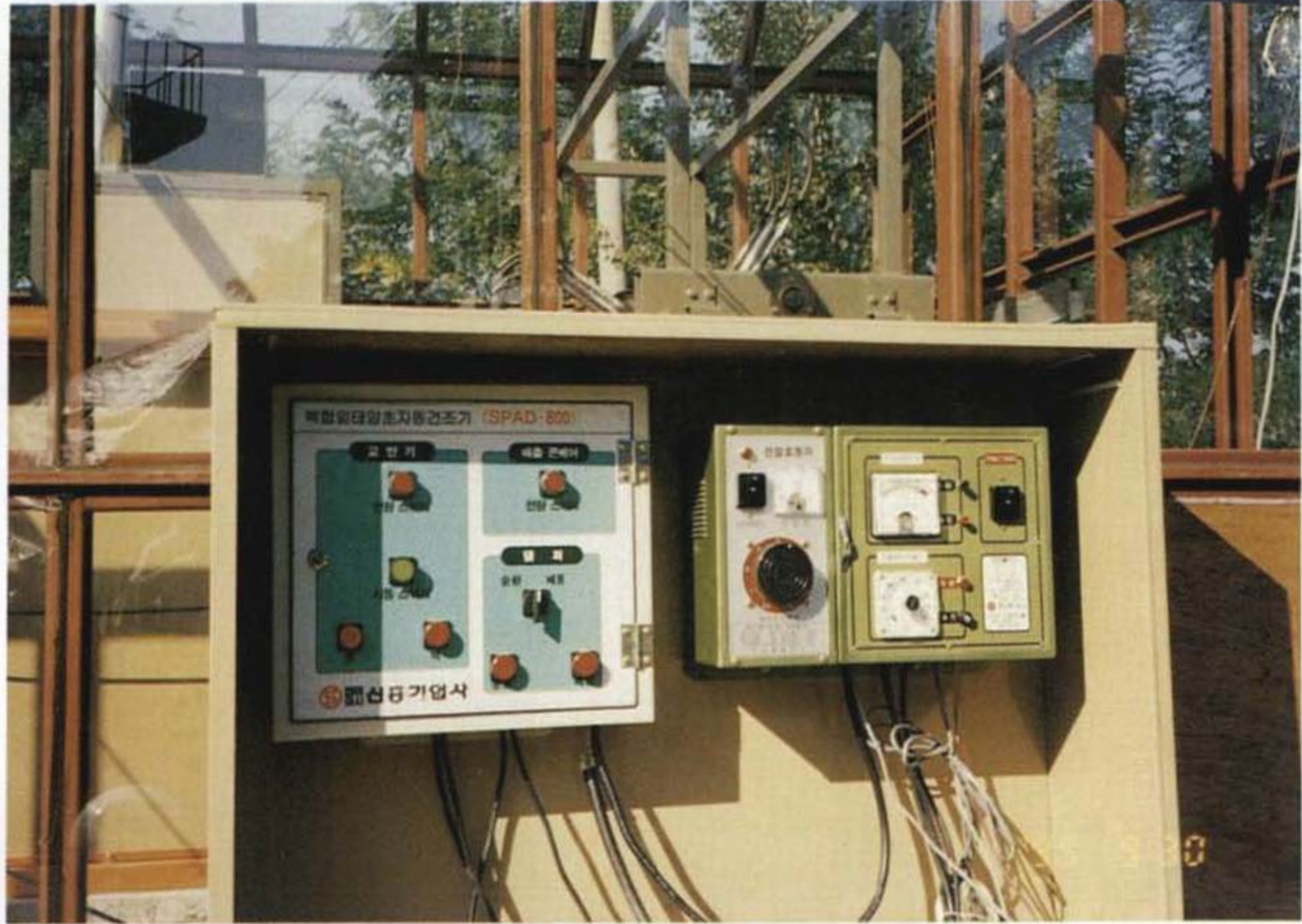
그림3-9 복합열 태양초 자동건조기의 제어장치
