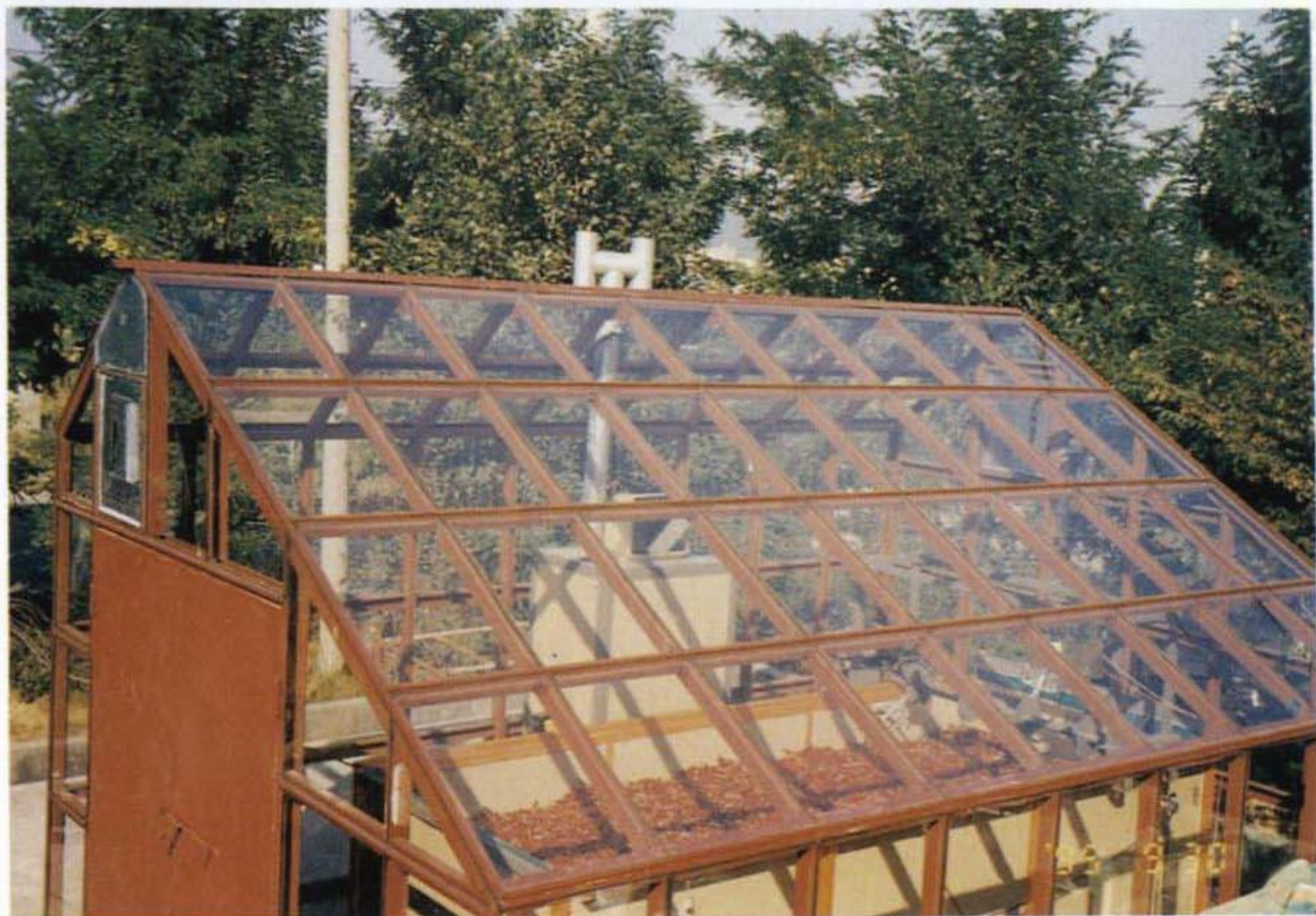
그림3-6 복합열 태양초 자동건조기의 건조실
