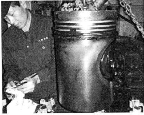
그림 4-27 연소실 내부 부식 및 마모도 등 상태 확인
