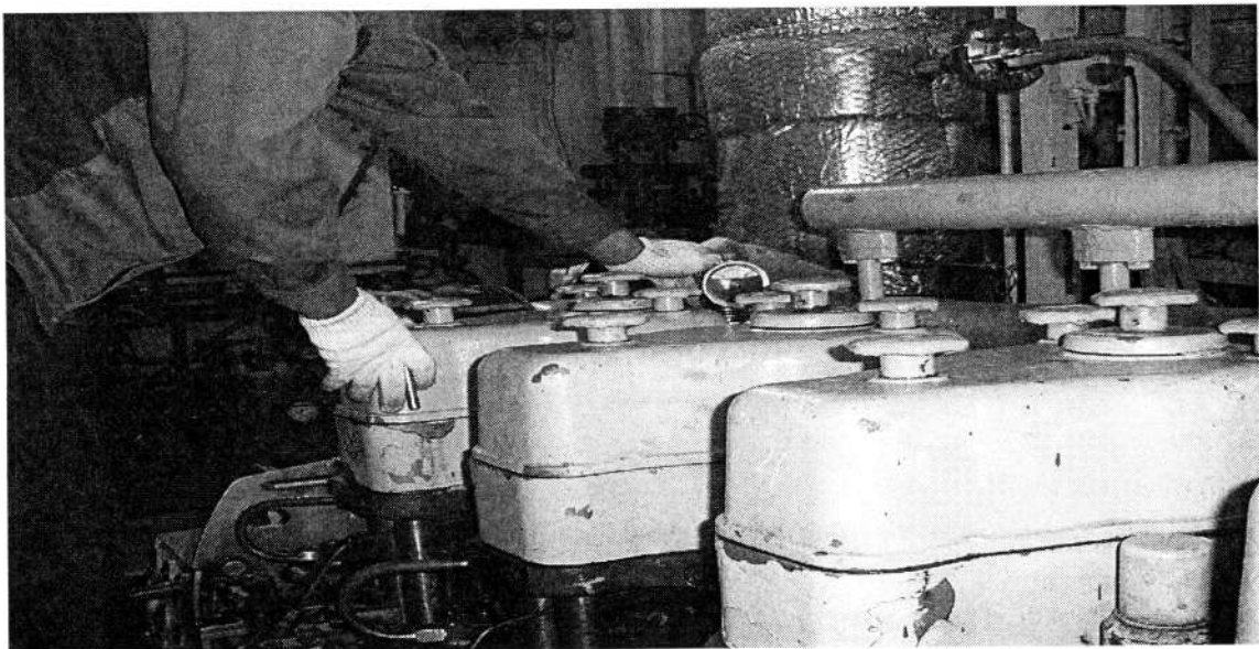
그림 4-22 풍림12호의 Pmax Gauge를 이용한 최대폭발압력(Pmax) 측정
