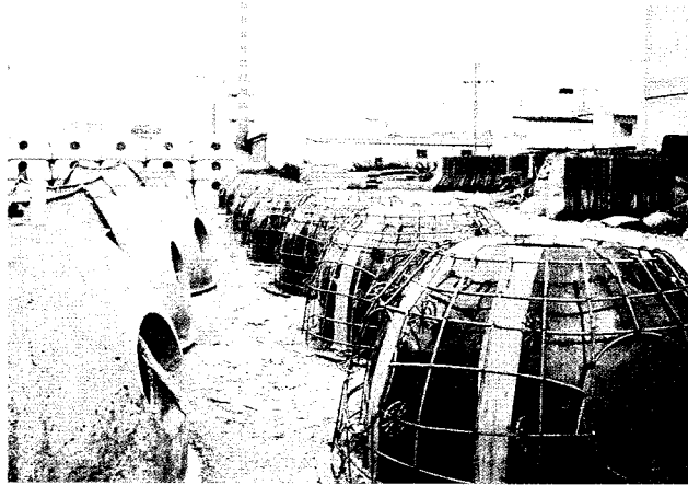
사진 26 인공어초 제작 모습(반구형 인공어초 거꾸집)
