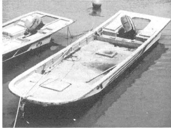
<그림 3-2-7> FRP 선외기 장착 작업선
