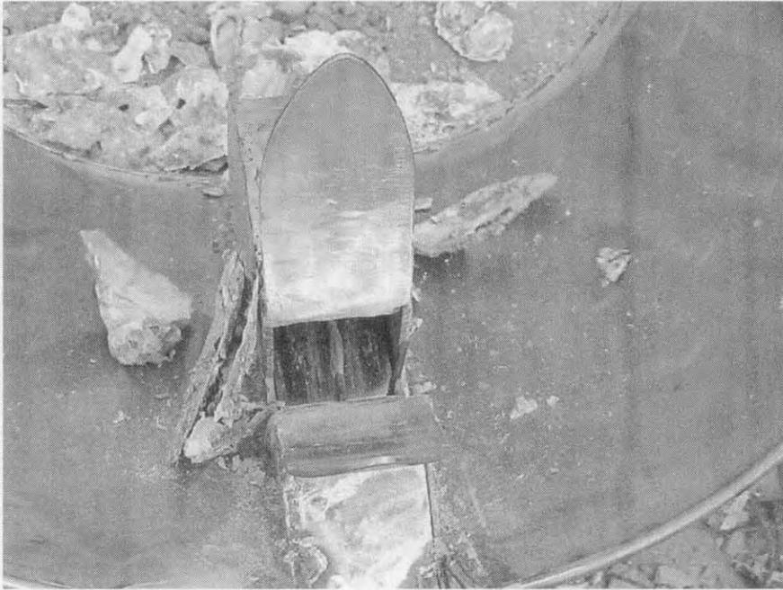
그림 72 코팅사가 제거된 굴 껍질이 배출가이드로 배출되는 상태
