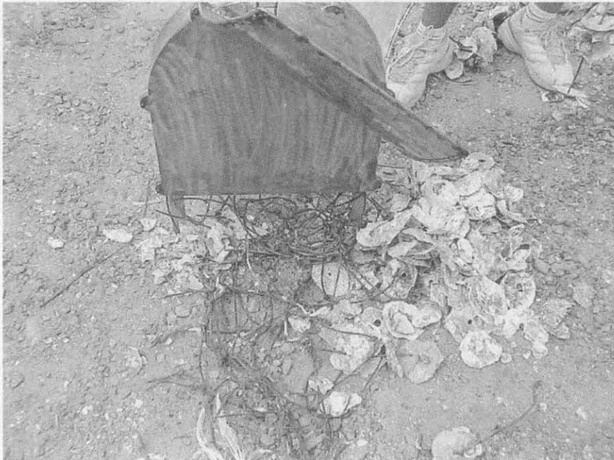
그림 73 굴 껍질 덩어리로부터 제거된 코팅사가 배출구로 배출된 상태
