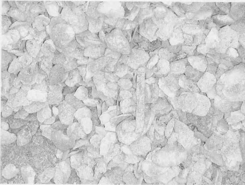
그림 55 분리되지 않은 크기가 작고 곧은 코팅사(5mm×27mm)
