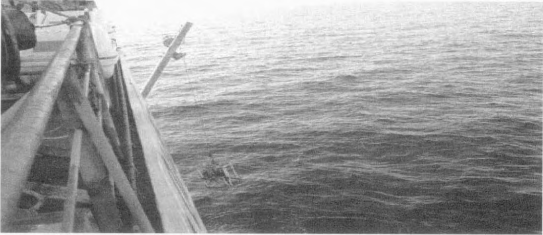
CTD를 이용한 연직수온 및 연직염분 측정
