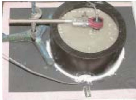
(사진 5) 시험 후 초속경시멘트의 경화시험
