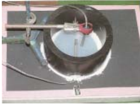
(사진 4) 시험 전 시료설치(K-타입열전대와 실리콘고무)
