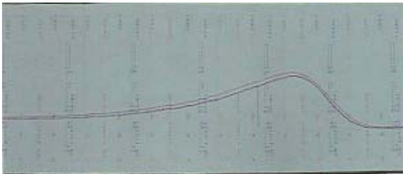
(사진 8) 초속경시멘트의 경화시간에 따른 온도변화
