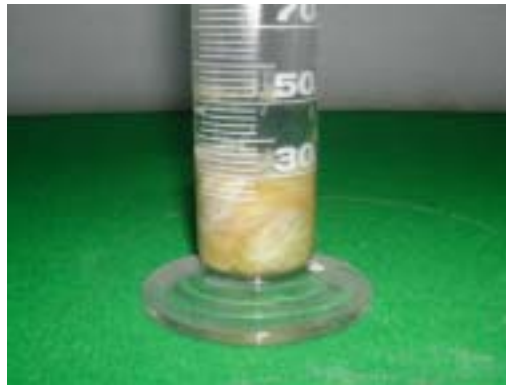
(사진 11) 에폭시 A +에폭시 B 혼합 믹싱 광경
