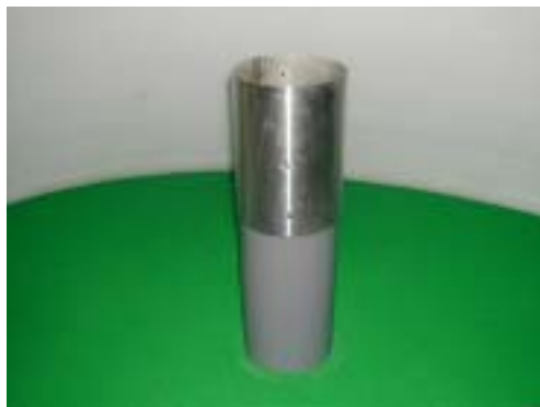
(사진 27) 연결소켓을 설치한 상태
