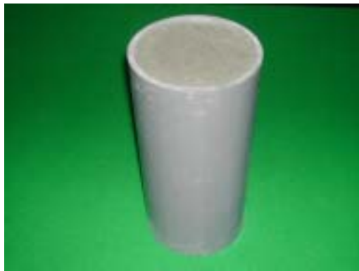
(사진 26) 하부에 부착되는 콘크리트 충전재
