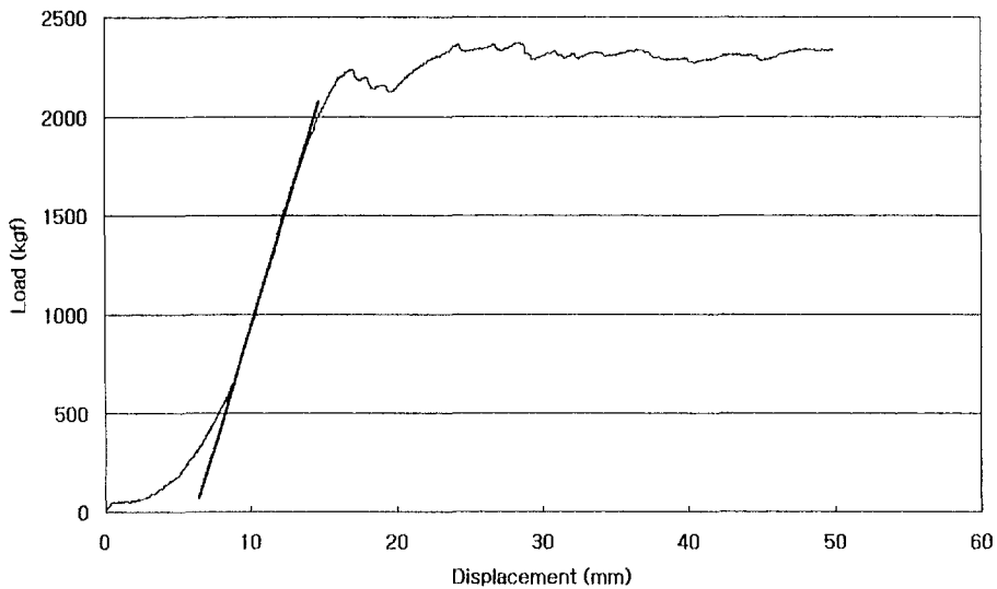
그림 4-60. 단순증가 하중 하에서 수평격판(OSB덮개, 접착제 사용, 8d 못)의 하중-변위선도.
