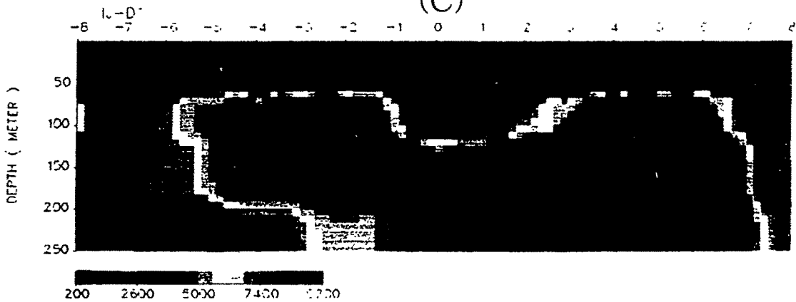
그림 39. 용수골 지구의 쌍극자 배열 전기 비저항 탐사 결과. (측선명 IJ-D1, a=50m, n=10) (A) 현장 측정 자료의 겉보기 비저항 가단면도. (B) 계산된 이론 자료의 겉보기 비저항 가단면도. (C) 역산 결과 해석된 2차원 진비저항 분포도.
