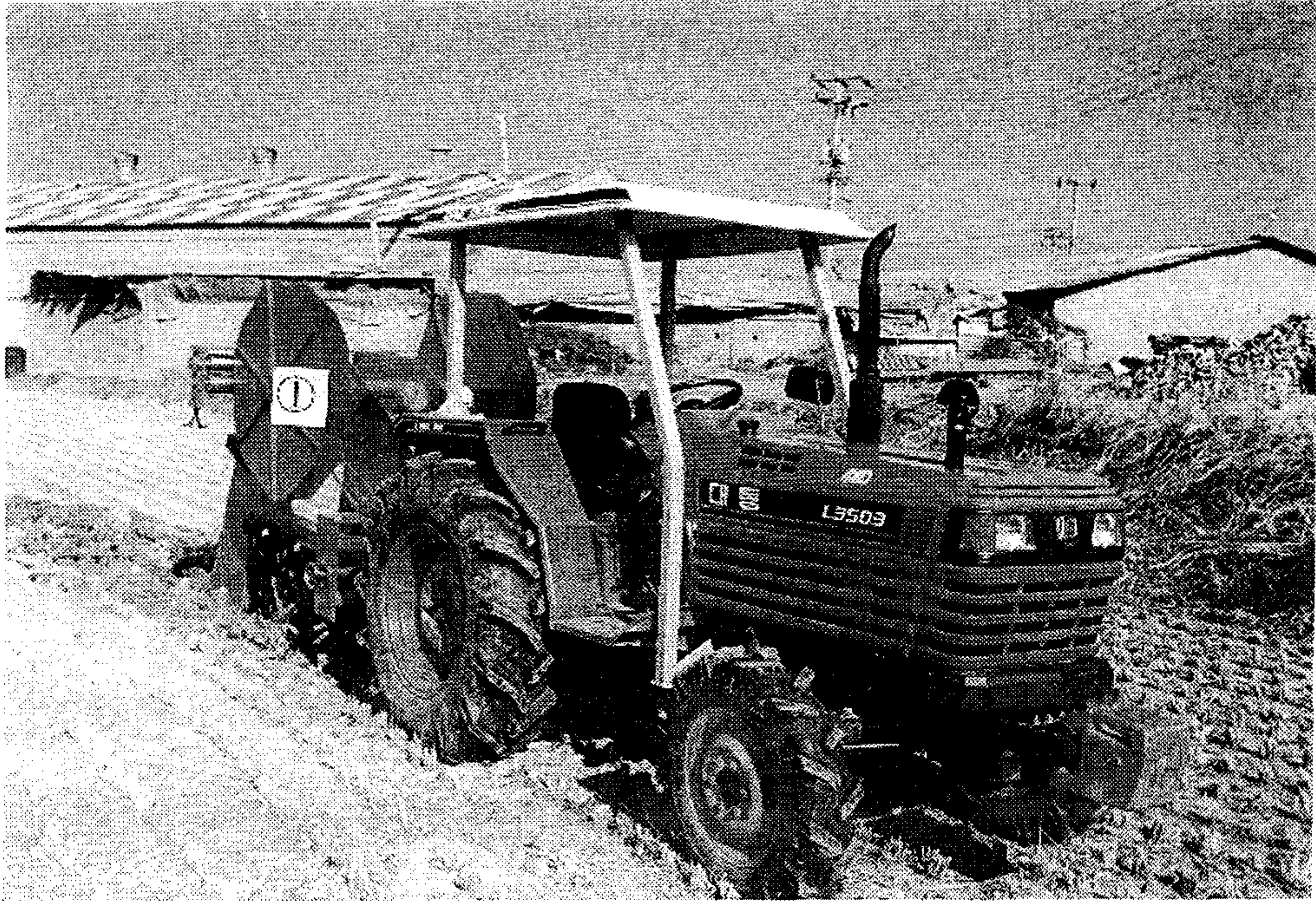
사진-1 트랙터에 장착된 드레인 설치장비
