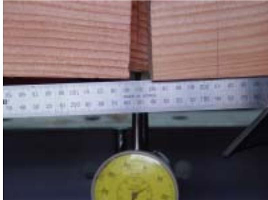
사진 4-33 게이지 설치
