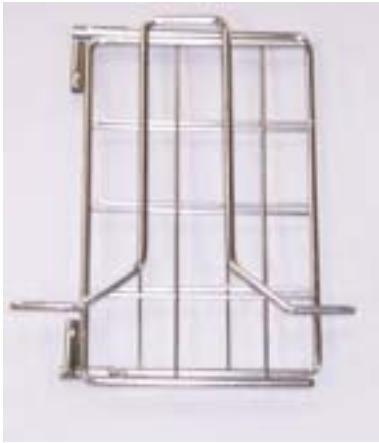
그림 1-49. 목화진딧물 간이에찰용 격자(grid) - 각 격자내 20구의 셀(3X3cm)들로 구성되어 있고 휴대하기 편하도록 조립과 분해가 간편함
