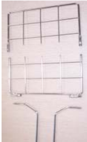
그림 1-49. 목화진딧물 간이에찰용 격자(grid) - 각 격자내 20구의 셀(3X3cm)들로 구성되어 있고 휴대하기 편하도록 조립과 분해가 간편함
