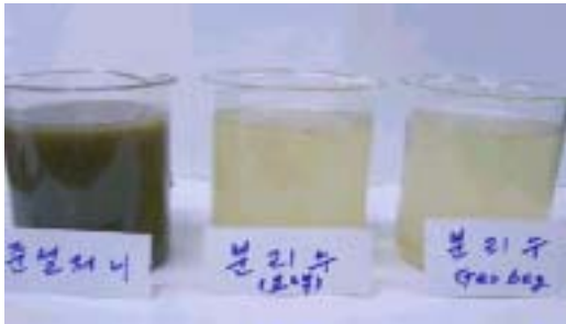
[사진 44] 준설저니고액분리 전/후
