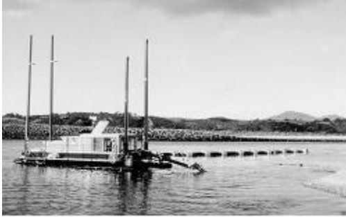
[사진 25] 소형펌프 준설선
