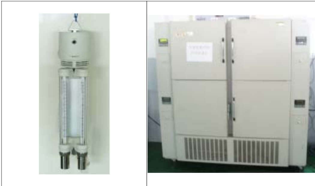
[그림3-39] 시험에 사용한 아스만 건습구계 [그림3-40] 시험에 사용한 향온 향습기
