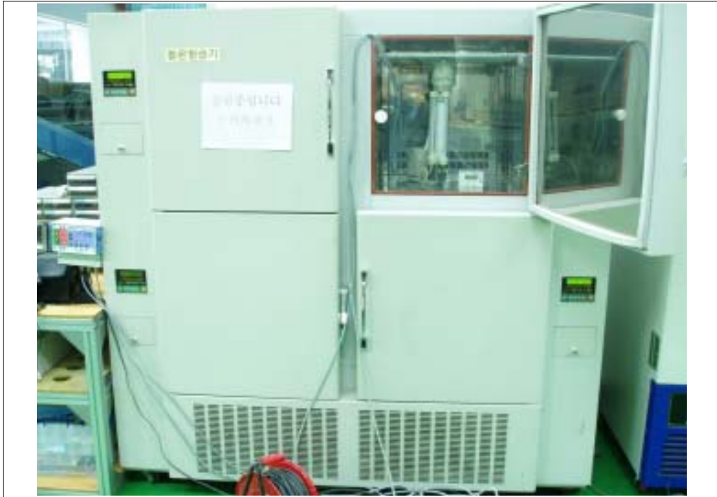
[그림3-41]. 항온 챔버에 온습도센서 및 아스만 건습구계 설치 시험모습
