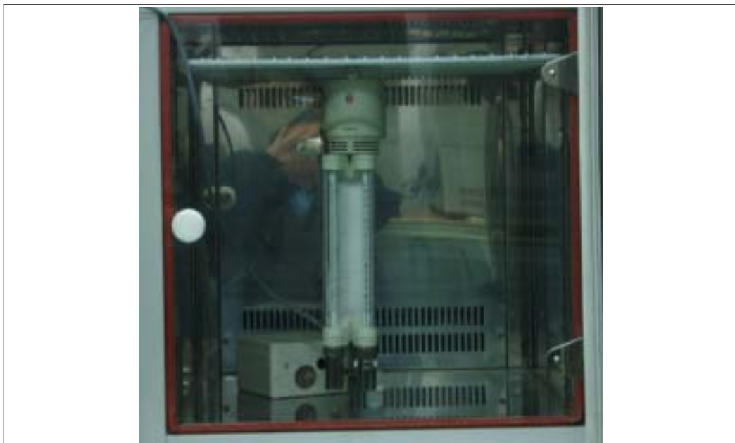
[그림3-42]. 항온 챔버 내의 온습도센서와 아스만건습구계
