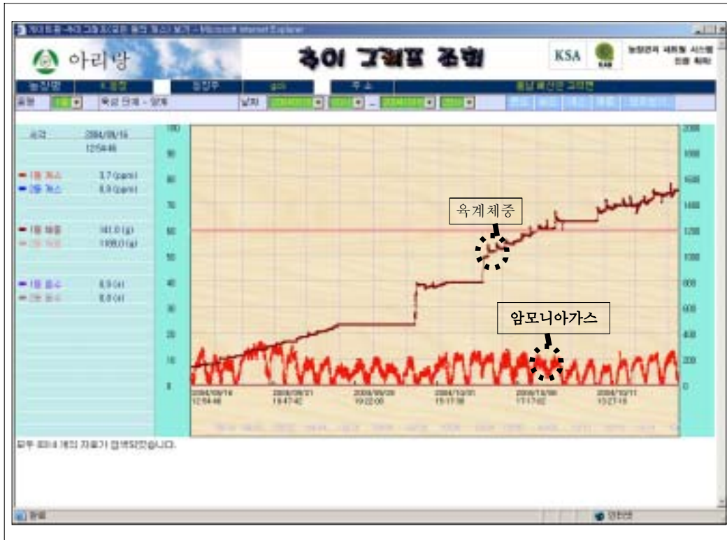
[그림3-54]. 시험농장 2 암모니아가스 측정 데이터(인터넷 환경)
