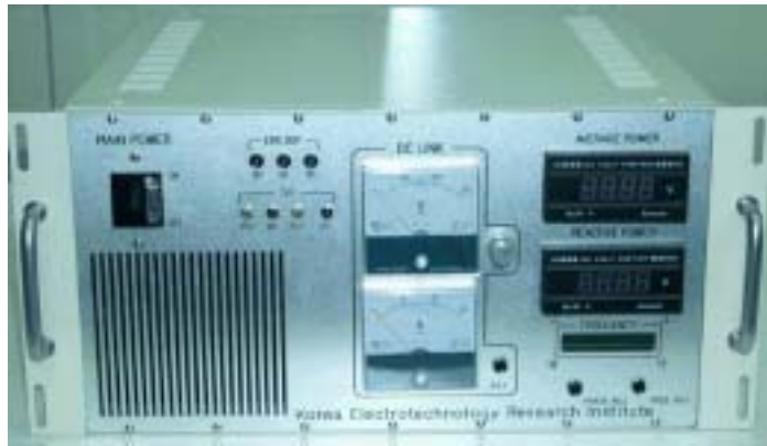
그림 3-34. 제작한 유도가열 전원 사진
