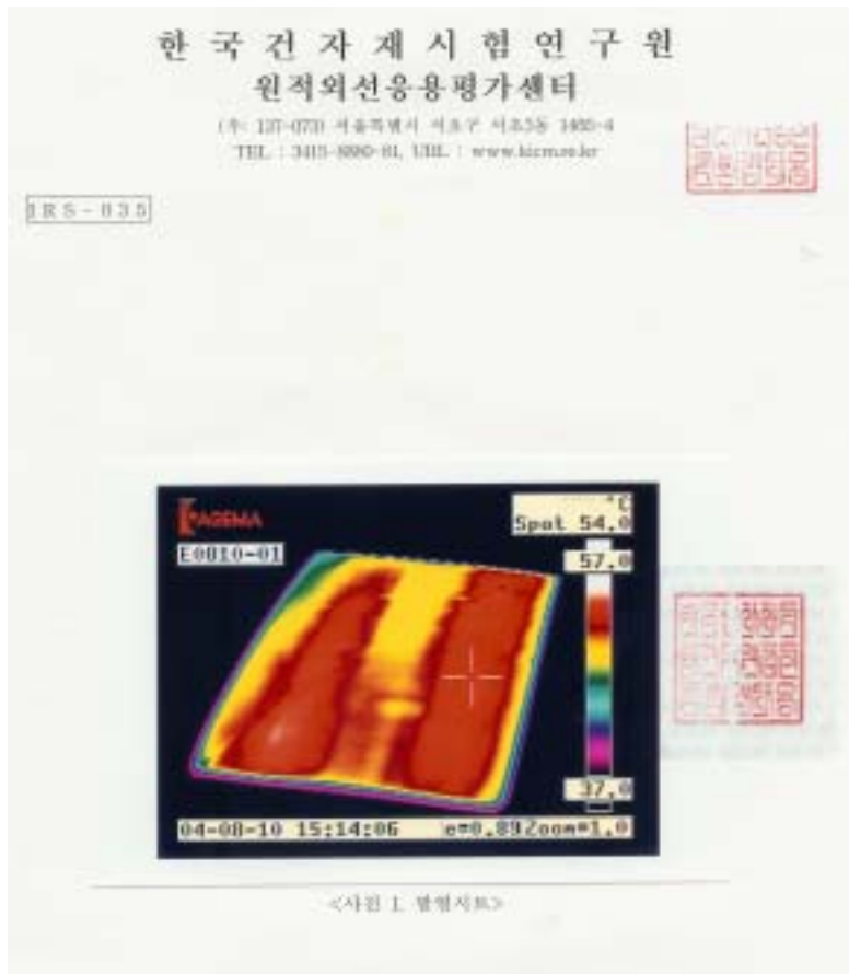
Fig. 19 발열시트의 적외선 열화상 측정
