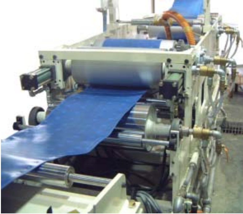
Fig. 11. 양면코팅 시 발열시트의 냉각과 이송을 위한 폴리싱 롤 및 cooling 롤
