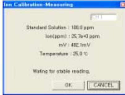
그림 3-41. 표준용액의 기준 농도 측정 결과
