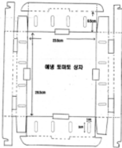
Fig 1. 자체 설계한 방울토마토 예냉용 골판지박스 (원예연구소 저장이용과, 2004)
