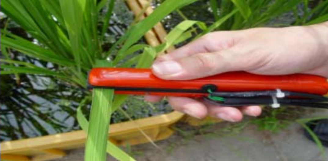
그림 3-102. 디지털질소측정기 시작기를 이용한 벼잎의 엽색도, 질소함량 측정모습
