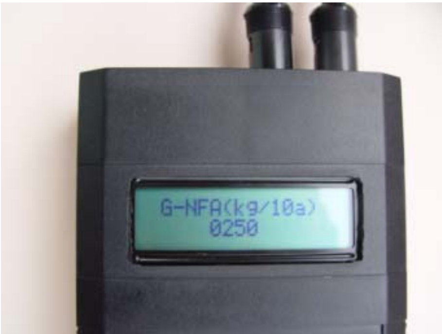
그림 3-105. 디지털질소측정기 이용 벼잎의 질소함량값 측정Ⅱ
