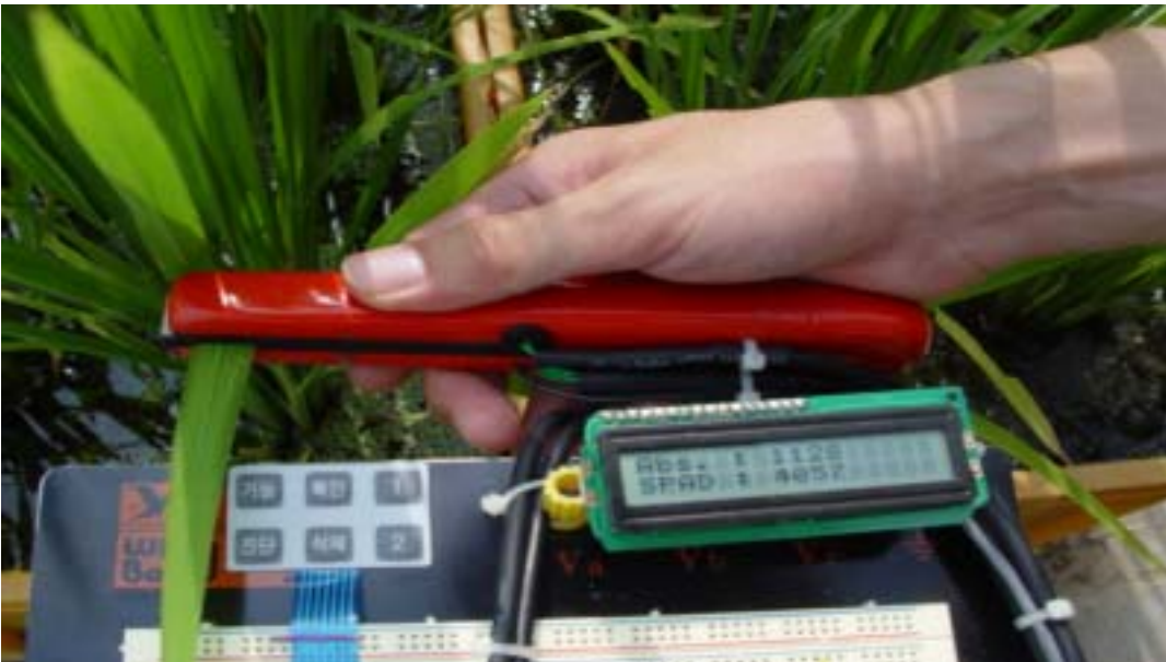
그림 3-103. 디지털질소측정기 시작기의 Absorbance 및 SPAD값 측정
