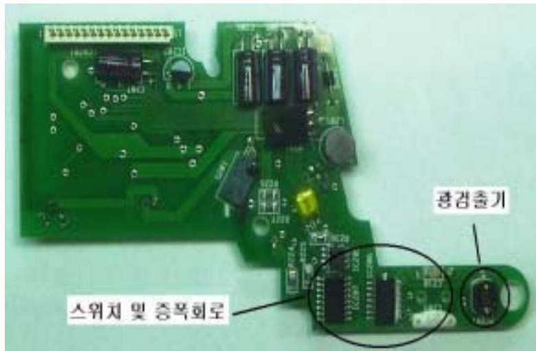
그림 3-30. 엽록소계의 검출기 및 증폭기부분
