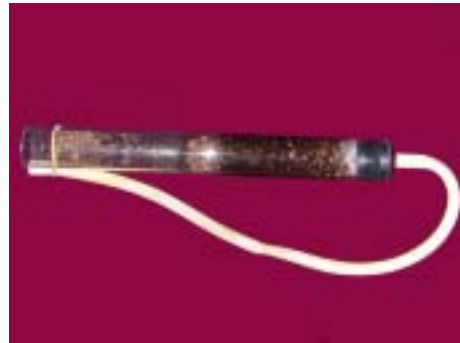
<그림 3> 조제된 미량원소복합제의 용출실험을 위해 제작된 컬럼 및 컬럼에 상토를 충전한 모습.
