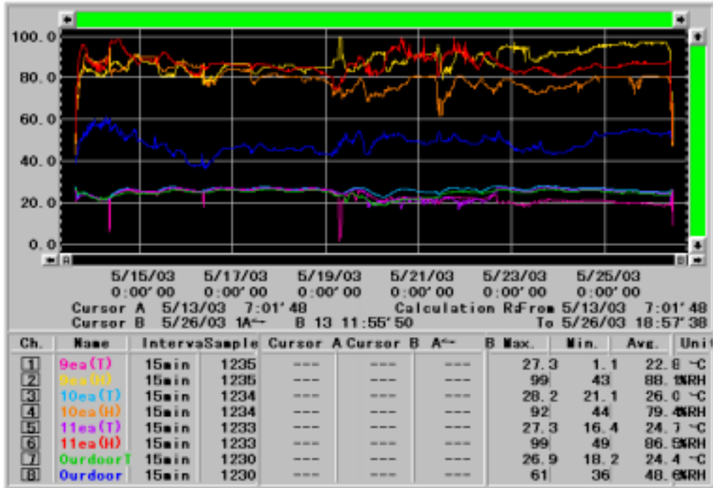
그림 4-60. 기공 수에 따른 두께 50 \mu m의 방담필름 포장재 내부의 온·습도변화
