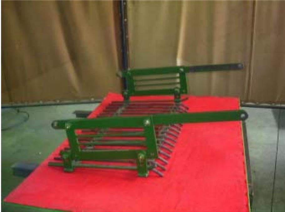
그림 11. 선별판이 부착된 S<sub>23</sub>S<sub>34</sub> 링크의 측면도
