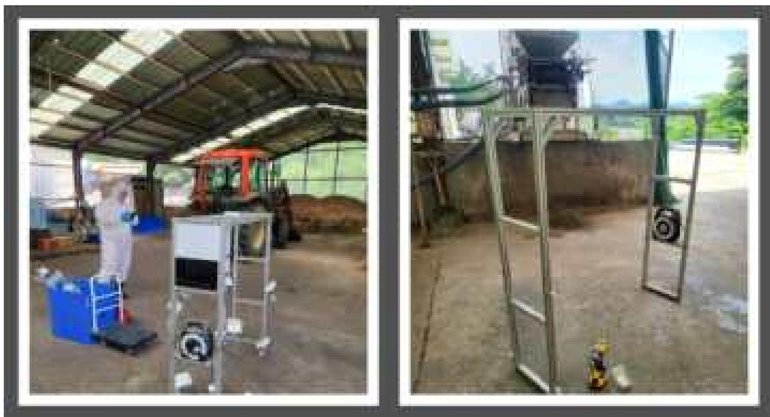
그림 55. 검정돈사내 3D이미지측정용 프레임 설치
